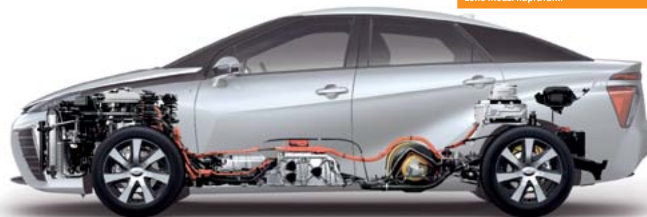
▼ Obr. 3: Prehľadné usporiadanie jednotlivých skupín pohonného systému automobilu. Zásobníky vodíka sú umiestnené v bezpečnej zóne medzi nápravami
