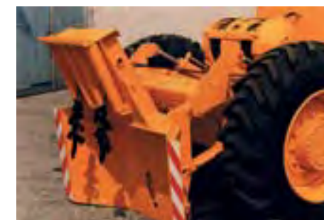
CHARAKTERISTICKÝ SKLOPNÝ ZADNÝ ŠTÍT LKT 81 S DVOJITÝM NAVIJAKOM
