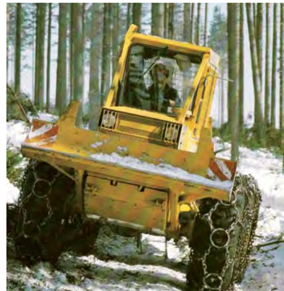
SÉRIOVÉ VERZIE LKT 81 OPÚŠŤALI VÝROBNÉ HALY TOVÁRNE ZŤS V TRSTENEJ VÁČŠINOU V SYTO ŽLTOM LAKU. PREDNÁ RADLICA SLUŽILA NA TZV. RAMPOVANIE KMEŇOV A TIEŽ NA VYKONÁVANIE DROBNÝCH TERÉNNÝCH ÚPRAV V LESE
