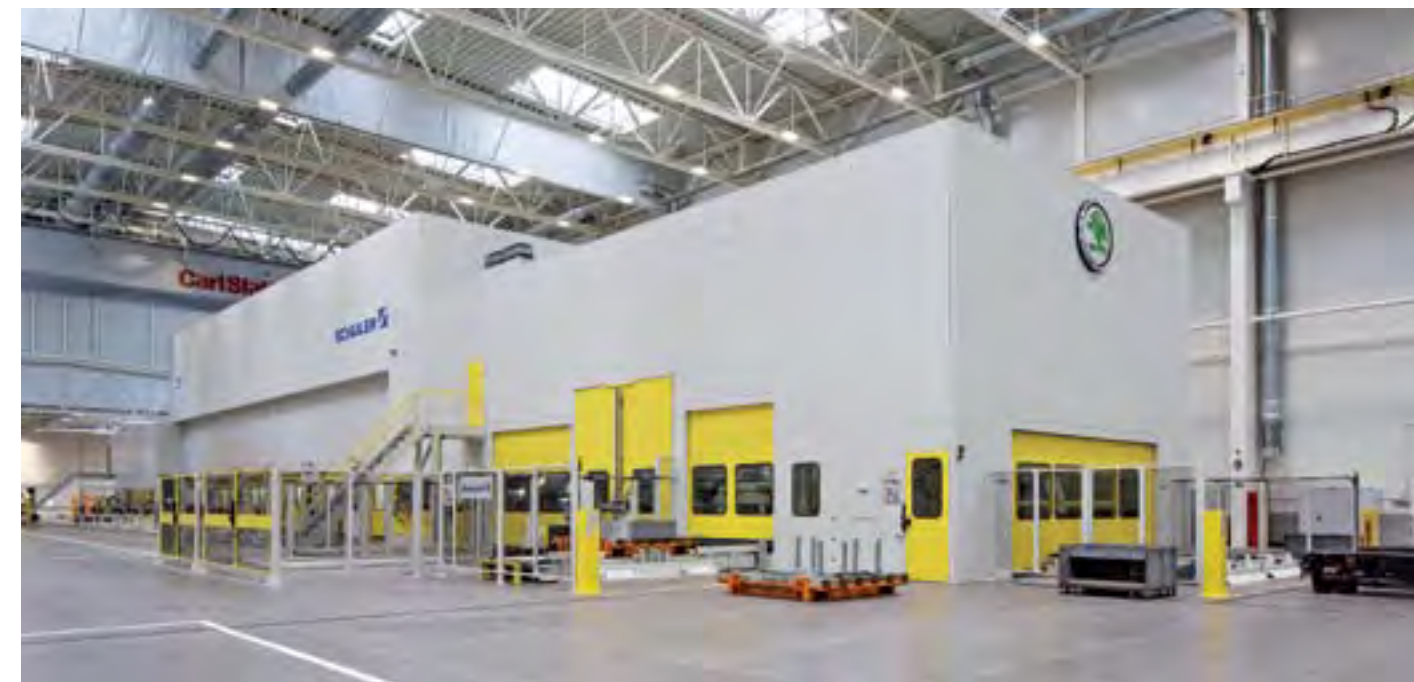
Lisovacia linka PXL II umožní aj lisovanie veľkých hliníkových dielcov
