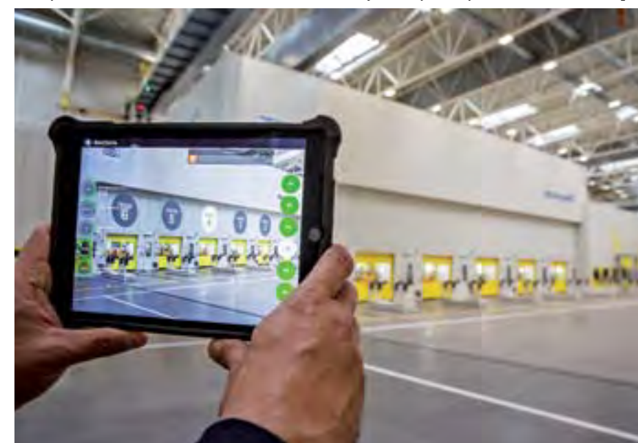
Pomocou rozšírenej reality (Augmented Reality) možno na tablete sledovať spotrebu energie, vzduchu, alebo skladové zásoby - pracovníci údržby tak vďaka rozšírenej realite na prvý pohľad vidia, či je všetko v poriadku
