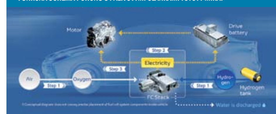
FUNKČNÁ SCHÉMA POHONU S PALIVOVÝMI ČLÁNKAMI TOYOTY MIRAI
