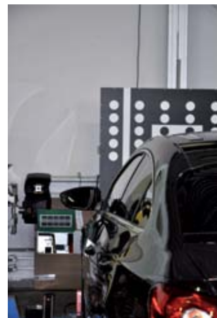
Prístroj CSC-Tool od spoločnosti HELLA GUTMANN Solutions umožňuje kontrolu a prípadné nastavenie pomocou kalibračných panelov v spojení s diagnostickými prístrojmi skupiny Gutmann mega macs a je do značnej miery univerzálny
