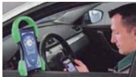
Zariadenie na pripojenie k elektronickému rozhraniu vozidla (HU-adapter) používané v Nemecku
