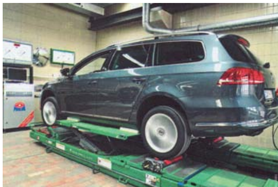
Skúšobňa MAHA MFP 3000 predstavuje možnú budúcu technológiu - umožňuje kontrolu funkčnosti a účinnosti elektronických bezpečnostných a asistenčných systémov
