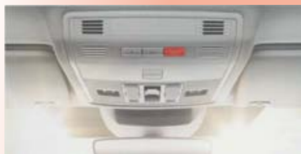
Umiestnenie tlačidla SOS systému pre núdzové volanie ako súčasť konektivity nových automobilov
