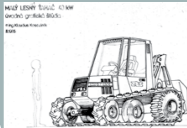
Vo výskumno-vývojovom ústave ZŤS v Martine vzniklo niekoľko zaujímavých štúdií lesných pásových strojov. Na fotografii návrh malého lesného ťahača MLT 40 od Klaudia Koscelníka z roku 1985
