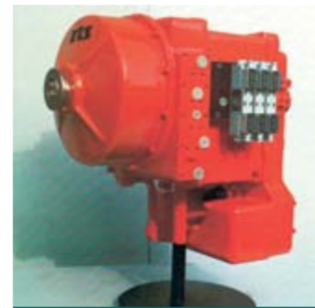
Pre novú generáciu ťahačov LKT 90 bola vyvíjaná hydrodynamická prevodovka ZTS 3HPR 75, jej sériová výroba sa však už naplno nerozbehla
