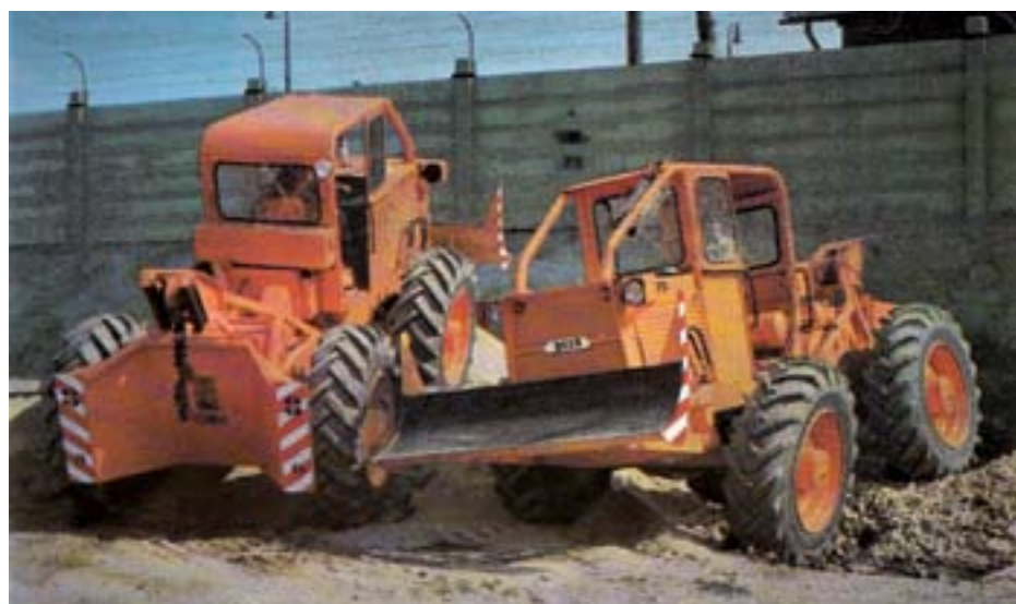
Pre prvý model lesného ťahača LKT 75 bola použitá prevodovka, ktorá vychádzala z upraveného agregátu PRAGA, určeného pre terénny nákladný automobil. V bývalom závode ZTS Prakovce sa v malých sériách vyrába dodnes.
