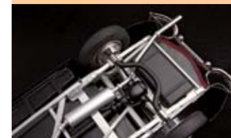
▲ Čiastočný pohľad zospodu v M 1:12 - stabilný kovový rám z vyformovaných hliníkových profilov, dvojklbová zadná os na kovových zväzkoch listových pružín, kompletný výfukový systém...
