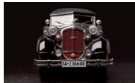
▲ Masku chladiča zdobia ručne natiahnuté vertikálne tyče z ušľachtilej ocele
