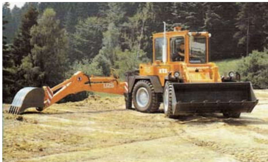
Univerzálny zemný stroj slovenskej značky ZŤS bol prvým sériovo vyrábaným rýpadlo-nakladačom s kĺbovým rámom na svete
