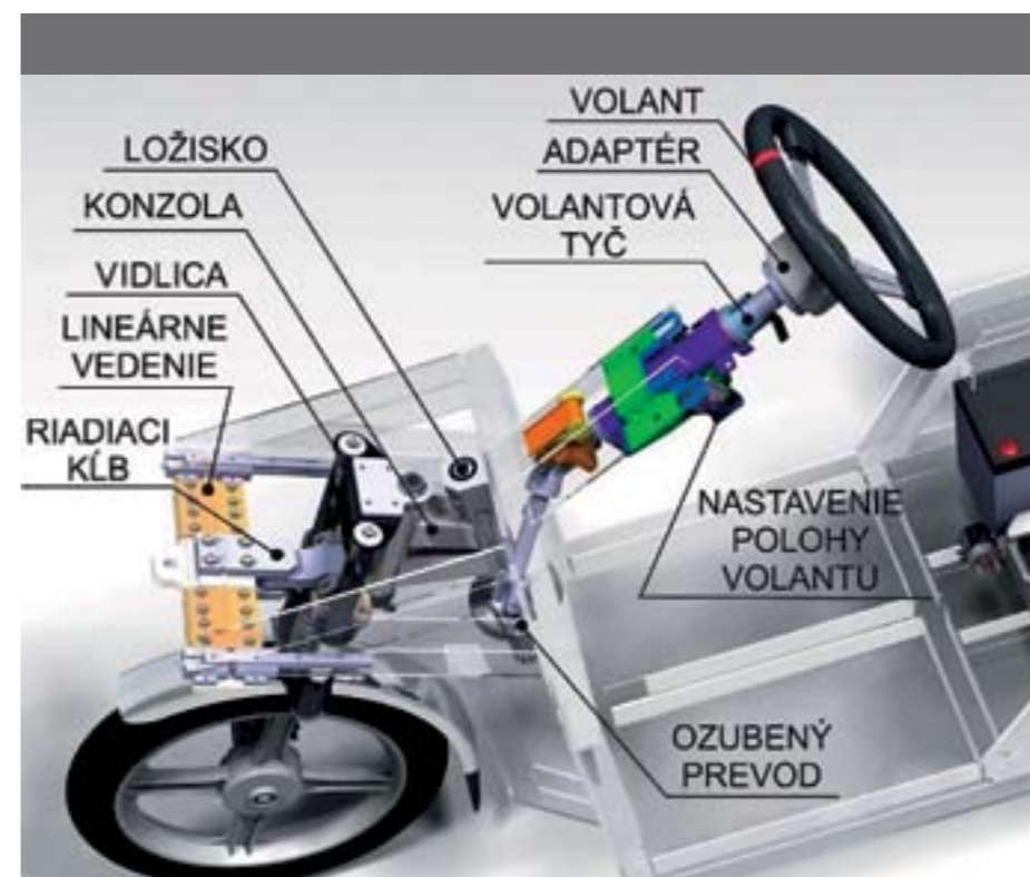
Obr. 5 3D pohľad konštrukčného usporiadania zavesenia predného kolesa vytvorený v programe CATIA
