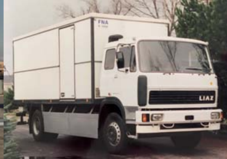
Valníkové podvozky sa často využívali pre montáž skriňových, ale i iných nadstavieb
