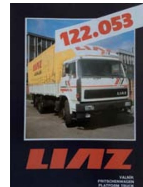
Vlajková loď automobilky, LIAZ 122.053 6x2 so zadnou vlečnou nápravou a pneumatickým pružením, na dobovom prospekte. Vozidlo s celkovou hmotnosťou 22 ton dosahovalo maximálnu rýchlosť 98 km/h, priemerná spotreba nafty bola 30 litrov/100 km
