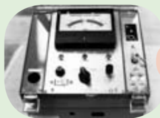
Prístroj na kontrolu teploty varu brzdovej kvapaliny CASTROL Vapour Lock Indikátor MARK III E
