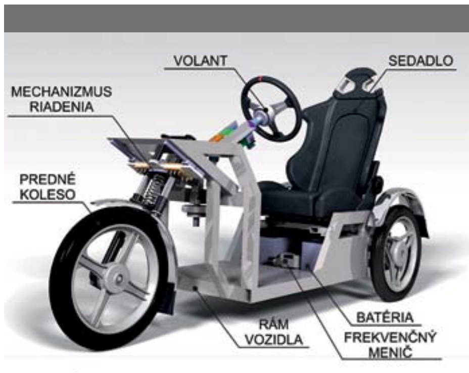
Obr. 6 Konceptný návrh vozidla s efektívnym a ekologickým pohonom vytvorený v programe CATIA
