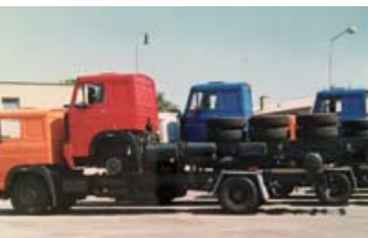
K preprave hotových podvozku k iným výrobcam nadstavieb využívali domyselný spôsob, ktorý šetril náklady
