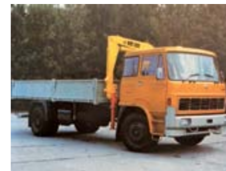
LIAZ 100.031 určený na montáž hydraulickej ruky HR3001, ktorú dodával závod BAZ Trnava
