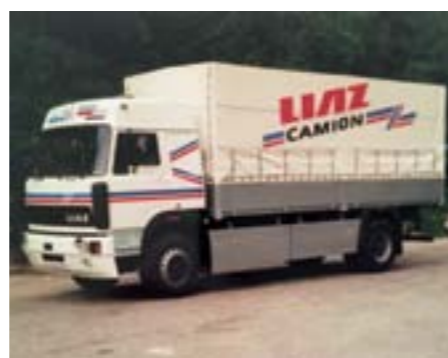
Valník novej generácie LIAZ 230.073 s modernizovanou kabínou typu MAXI. Vozidlo s celkovou hmotnosťou 17 ton dosahovalo maximálnu rýchlosť 98 km/h
