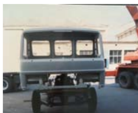
Skelet kabíny, ktorý dodával sesterský závod O9 LIAZ Holýšov. Finalizácia kabíny prebiehala vo Zvolene, a to montážou výbavy a nalakovaním
