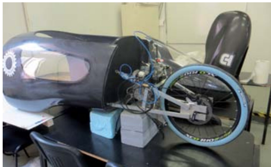
▲ Obr. 1 Uchytenie zadnej nápravy a príprava na jej skúšanie.
