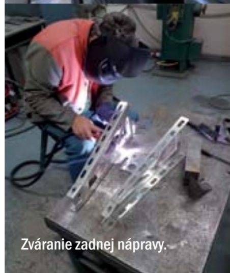
▲ Obr. 1 Uchytenie zadnej nápravy a príprava na jej skúšanie.
