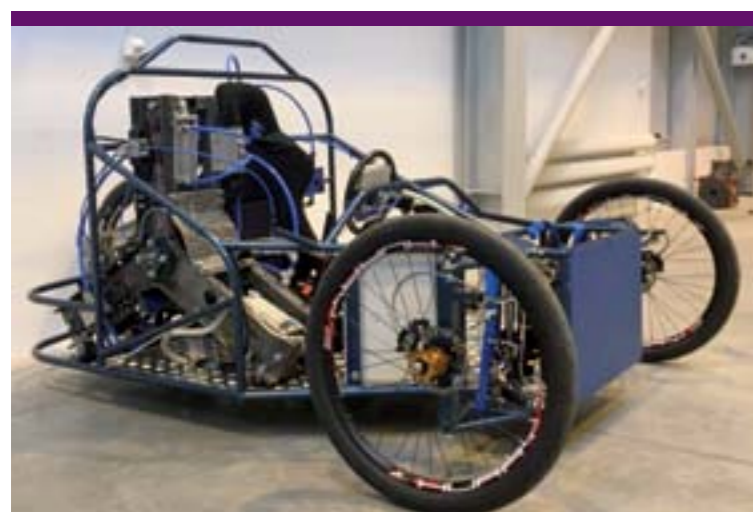
OBR. 10 CELKOVÝ POHLAD NA PNEUMOBIL
