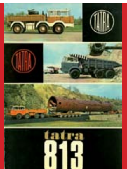
POHĽAD NA DOBOVÝ PROSPEKT CIVILNÝCH VERZIÍ TYPU TATRA 813. HORNÁ FOTOGRAFIA PREDSTAVUJE POMERNE ROZŠÍRENÝ CESTNÝ ŤAHAČ T813 TP 6X6, V STREDE PROTOTYP JEDNOSTRANÉHO SKLÁPAČA, KTORÝ SA NAKONIEC DO SÉRIOVEJ VÝROBY NEDOSTAL
