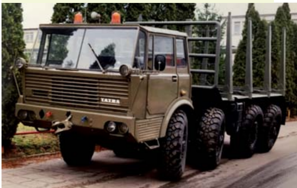
NIEKOTRÉ VOJENSKÉ PODVOZKY BOLI PO VYRADENÍ Z ARMÁDY ZREPASOVANÉ A UPRAVENÉ PRE CIVILNÉ POUŽITIE. NA FOTOGRAFÍI VOZIDLO T813 8X8 S KRÁTKOU KABÍNOU A NADSTAVBOU NA ODVOZ DREVA
