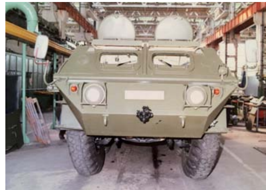
PODVOZOK T815 VP31 NA KONCI MONTÁŽNEJ LINKY. ICH VÝROBA BOLA UMIESTNENÁ V SAMOSTATNEJ HALE, ODDELENEJ OD HLAVNEJ PRODUKCIE VOZIDIEL TATRA 815
