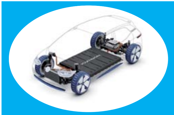
Obr. 1: Umiestnenie trakčnej batérie elektromobilu v podlahovej plošine karosérie pri platforme VW pre viaceré modely
