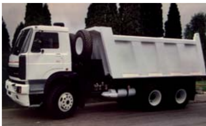
Prototyp jednostranného sklápača Tatran / Fatran S1 6x6 s celkovou hmotnosťou 28,5 ton
