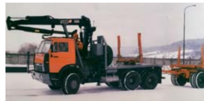
Lesovoz KATASI 5526 z roku 1996 určený na prepravu dlhých kmeňov stromov
