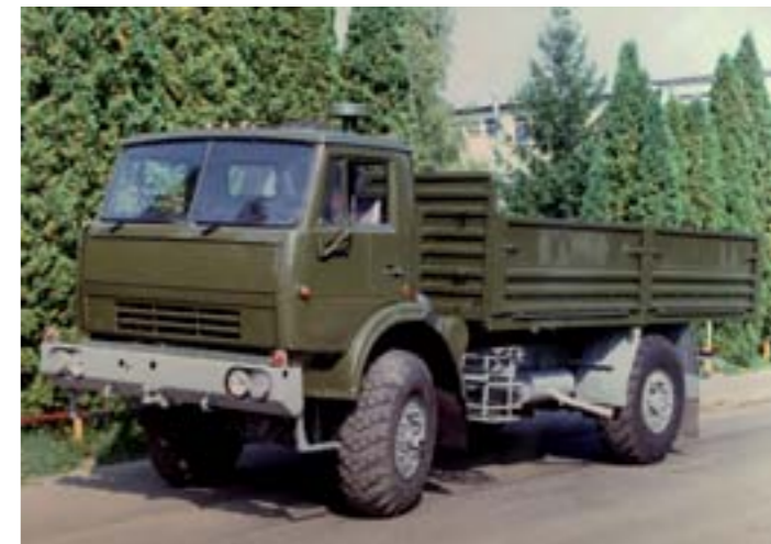
Prototyp vojenského dvojnápravového valníka KATASI 4x4 s pravostranným riadením pre indickú armádu
