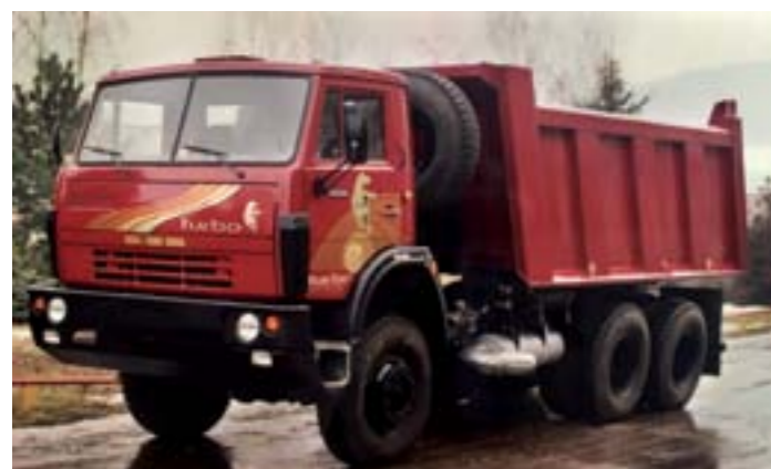
V rokoch 1995-96 vznikla tridsaťkusová séria jednostranných sklápačov KATASI S1 6x6, postavených na tatrováckom podvozku s hnacím agregátom a kabinou KAMAZ.
