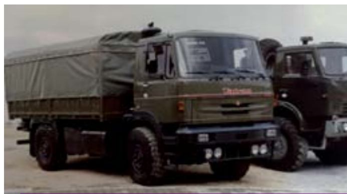
Dvojnápravový valník Tatran, resp. Fatran 4x4, postavený na tatrováckom podvozku s výkyvnými polnápravami, s motorom a kabinou LIAZ. Celková hmotnosť dosahovala 16 ton (fotografia archív Jozef Filanda)
