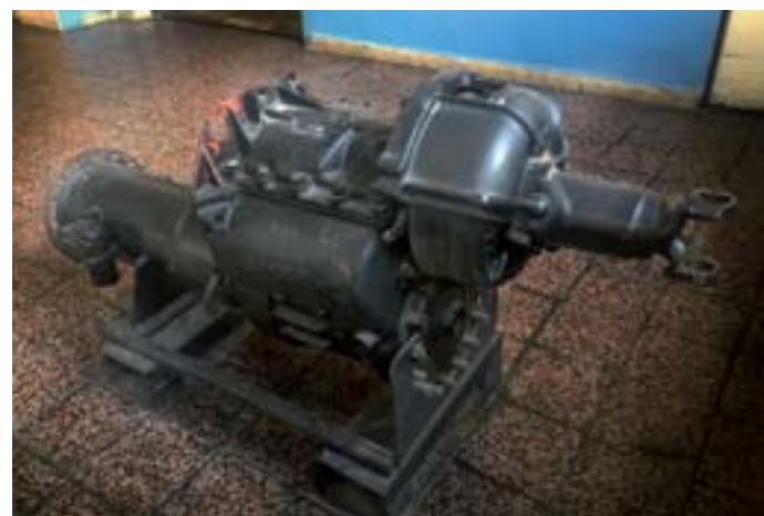
Časť typického podvozku nákladného automobilu Tatra s prídavným prevodom a s pomocným pohonom, dodnes vystavená vo vestibule výrobnéj prevádzky
