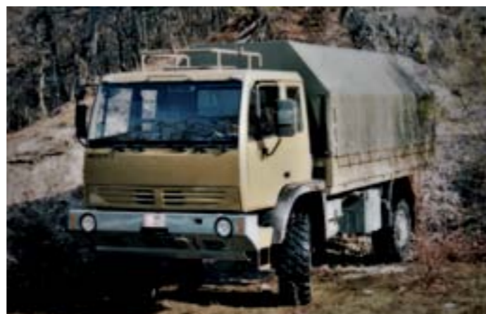
▲ Jeden z prvých prototypov vozidiel STA, ktoré neskôr dostali označenie AKTIS. Boli postavené v rokoch 1998-1999 ▼ Uvažovalo sa s využitím i v civilnom sektore, napríklad verziou STA AKTIS AW11 4x4.1R s výmennou nadstavbou rozmetadla priemyselných hnojív
