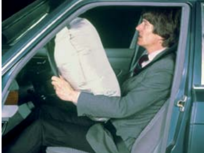
▲ Bezpečnostný vankúš ako záchranca života: od júla 1981 je k dispozícii kombinácia bezpečnostného vankúša pre vodiča a napínača bezpečnostného pásu pre spolujazdca – najprv exkluzívne v triede S konštrukčného radu 126, od začiatku roku 1982 aj pre všetky ostatné osobné vozidlá značky Mercedes-Benz. Od roku 1992 patrí čelný bezpečnostný vankúš do sériovej výbavy všetkých osobných motorových vozidiel značky Mercedes-Benz
