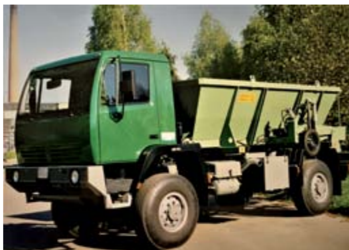
▲ Jeden z prvých prototypov vozidiel STA, ktoré neskôr dostali označenie AKTIS. Boli postavené v rokoch 1998-1999 ▼ Uvažovalo sa s využitím i v civilnom sektore, napríklad verziou STA AKTIS AW11 4x4.1R s výmennou nadstavbou rozmetadla priemyselných hnojív
