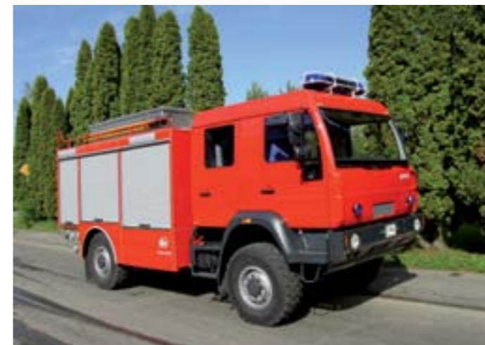
▲ Prototypy STA absolvovali náročné skúšky i na polygóne v bývalom materskom podniku v Kopřivnici ◀ Požiarne vozidlo so zdvojenou kabínou. Nadstavbu dodala spoločnosť THT Polička
