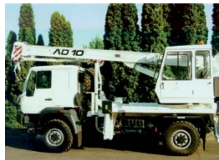
▲ Autožeriav ČKD Slaný AD10 na podvozku AKTIS 4x4.1R
