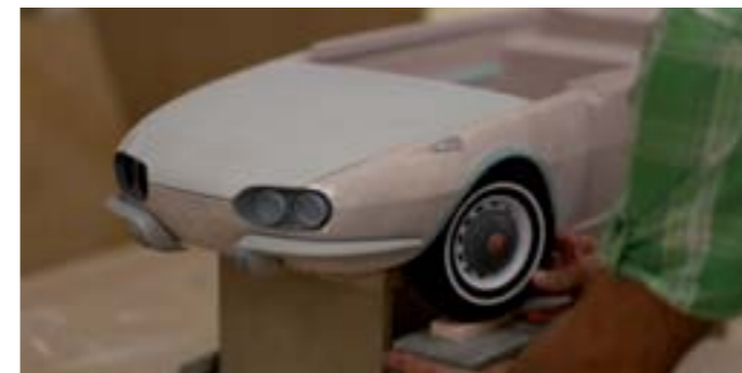
▲ Proces tvorby pevného modelu v mierke 1:4
