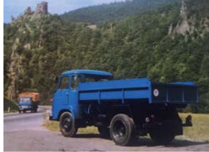
Pomerne rozšírené boli i ľahké jednostranné sklápače Avia 30 K-S na prepravu sypkých materiálov na krátke a stredné vzdialenosti. Celková hmotnosť vozidla bola 5,95 t pri nosnosti 3,01 t. Zubové čerpadlo hydraulického sklápania korby bolo napojené na pomocný pohon umiestnený na ľavej strane hlavnej prevodovky, sklápací mechanizmus bol ovládaný priamo z kabíny
