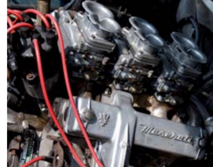
Šesťvalcový motor v tvare V bol pred prednou nápravou. V júli 1972 nahradili tri zdvojené karburátory Weber elektronickým vstrekovaním Bosch D-Jetronic
