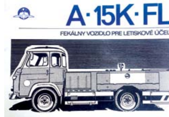
Ďalší z účelových automobilov vyvinutý a vyrábaný v žilinskej Avii: fekálne vozidlo A15 K-FL na obsluhu kabínovej nadstavby lietadiel s tromi nádržami (vodná, fekálna a dezinfekčná) s celkovou hmotnosťou 4,18 t
