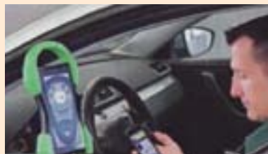
Obr. 1: Zariadenie na pripojenie k elektronickému rozhraniu vozidla (HU – adapter) používané v Nemecku
