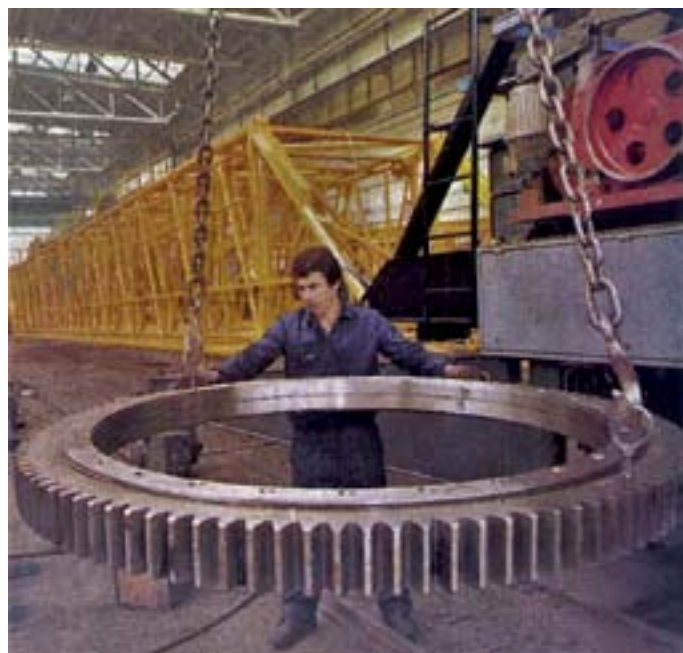
Veľkorozmerové ložiská montovali okrem iného aj do vežových žeriavov. V ich výrobe dnes pokračuje spoločnosť PSL
