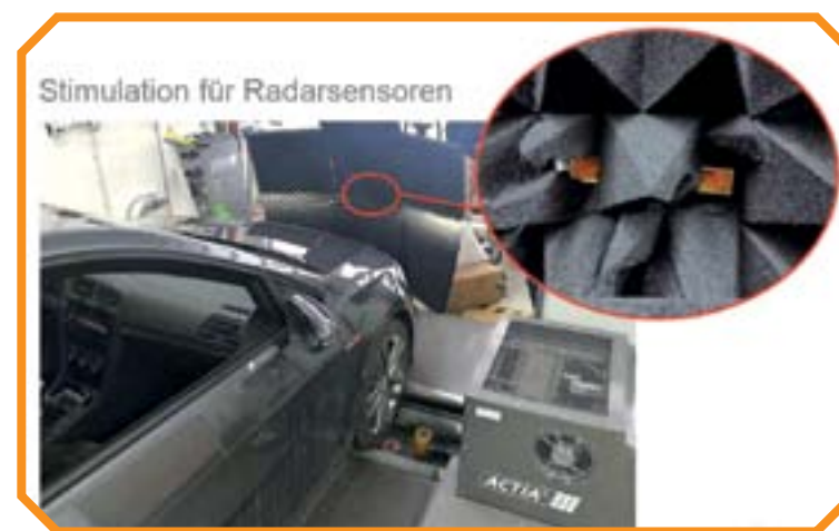
Obr. 4: Overenie funkcie radarových snímačov ich stimuláciou na experimentálnom pracovisku spoločnosti DEKRA
