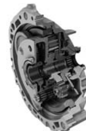
Príklad použitia ihličkových ložísk v oblasti autopriemyslu: Pohon „e-osi“ od spoločnosti Schaeffler vyrábaný pre Audi e-tron od roku 2018
