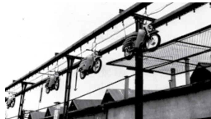
Nové motocykle dopravované z montážnej linky pomocou závesného dopravníka
