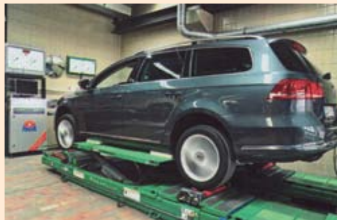
Obr. 3: Skúšobňa MAHA MFP 3000 predstavuje príklad možnej budúcej technológie – umožňuje kontrolu funkčnosti a účinnosti elektronických bezpečnostných a asistenčných systémov
