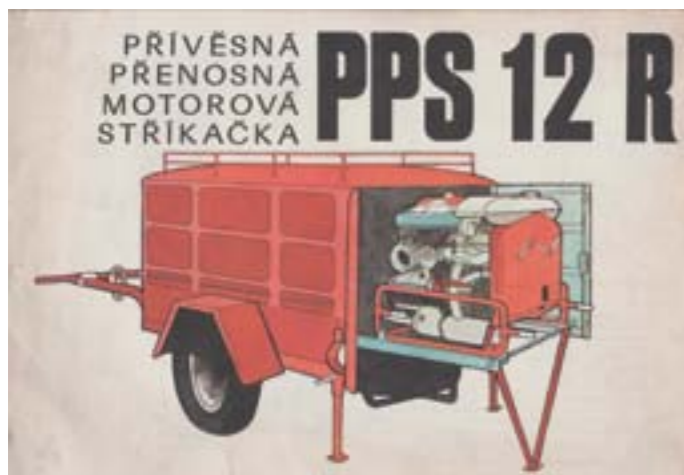
Motor Š1202 a neskôr Š1203/Š776 poháňali pojazdné hasiace striekačky PPS12 zo závodu SVA Holýšov a BAZ Skalica
