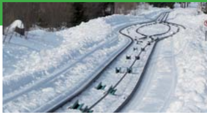
Obr. 8 Vodiace kladky lana zákrutové (naklonené) aj priame na rovnom úseku trate
