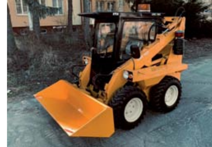
▲ Dodnes veľmi rozšírený šmykom riadený nakladač UNC 060 vyrábaný od roku 1981 v ZĽS Krupina. Na fotografií stroj v pôvodnom stave po precízne vykonanej renovácii (foto DETVA Industries)
