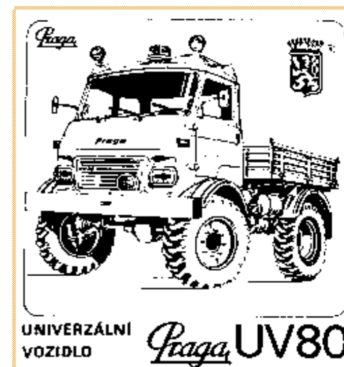
Na konci osemdesiatych rokov predstavila Praga prototyp univerzálneho komunálneho vozidla Praga UV80 s upravenými portálovými nápravami z TAZu (foto archív Vladimír Botta)
