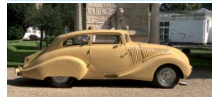
Wikov 35 s aerodynamickou karosériou sa objavil v roku 1931. Išlo o prvý československý sériovo vyrábaný automobil prísnych aerodynamických tvarov. Bol to ambiciózný projekt, ktorý podstatne predbehol dobu a pravdepodobne kvôli tomu nespĺnil pôvodne očakávania výrobcu. Vyrábalo sa pravdepodobne len päť kusov a ani jeden sa nezachoval. Na fotografii je novodobá kópia na originálnom podvozku
