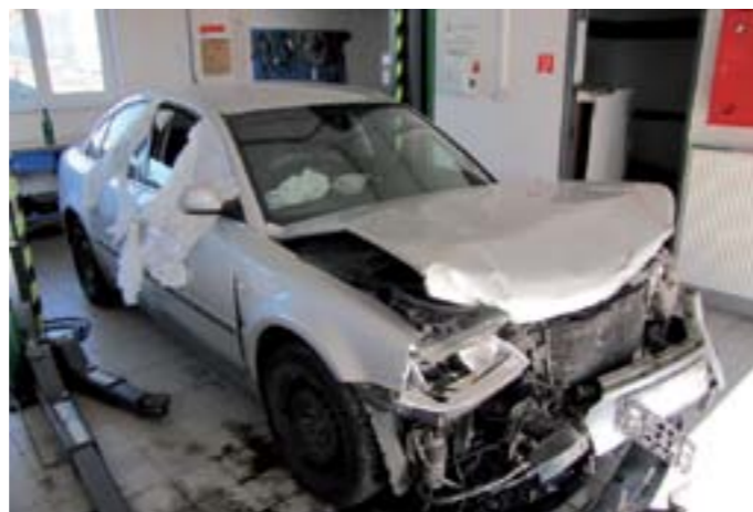
Vozidlo po dopravnej nehode, ktorá mala vplyv na všetky hlavné bezpečnostné prvky vozidla a je predurčené na opravu v certifikovanom mieste opravy
