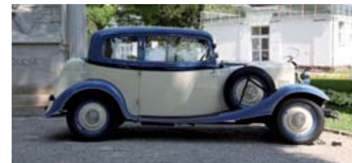
Táto dvojdverová štvormiestna limuzína Wikov 35 bola v dobových materiáloch označovaná názvom conduite intérieur. Charakteristickým prvom je prehnutá línia dverí, ktorá dodala karosérii elegantný tvar
