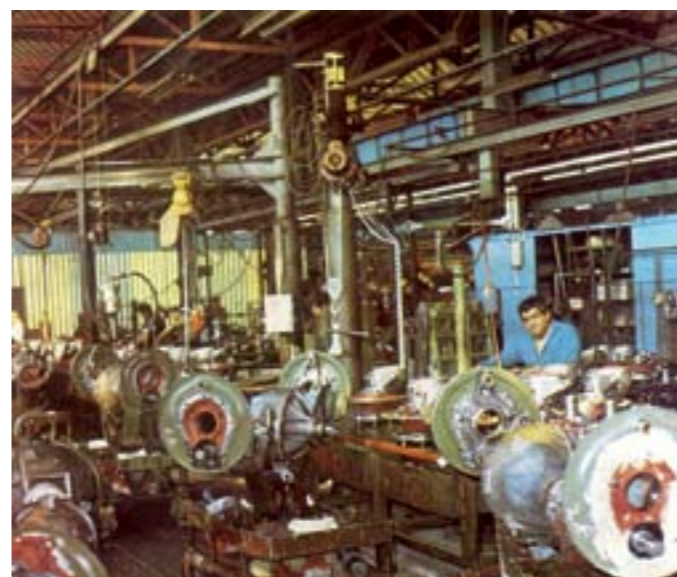
▲▼ Podnik v roku 1964 prevzal výrobu predných a zadných portálových náprav nákladných automobilov Praga V3S, po roku 1967 začal dodávať i prvé komponenty nákladných automobilov T813 a pohonné jednotky Š1202
