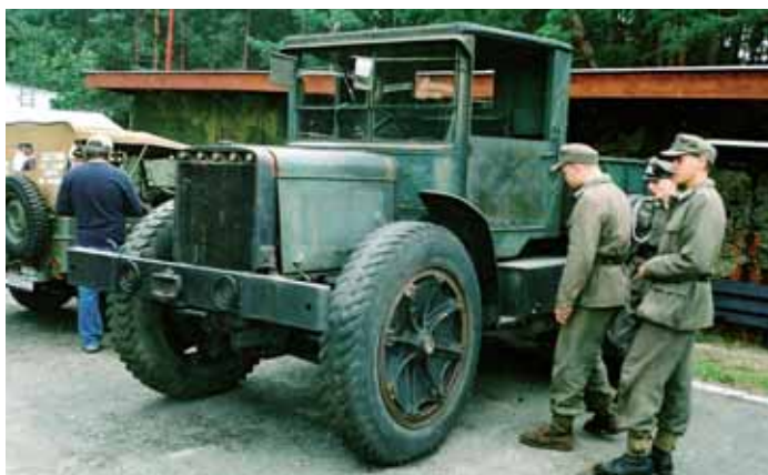
Taliansky delostrelecký ťahač Breda 130 mal zážihový motor so zdvihovým objemom 9635 cm 3
