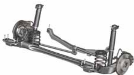
Obr. 9 Vlečená náprava s Wattovým priamovodom - Opel Astra 2009 [5]
