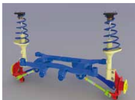
Obr. 14 Pohľad na nápravu bez tlmičov a so vzperami MacPherson
