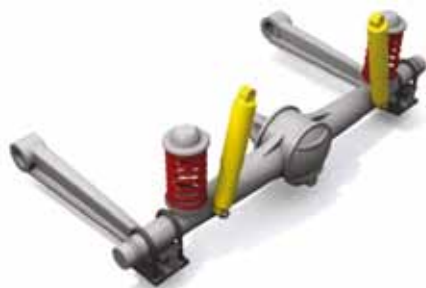
Obr. 2 Závísle zavesenie s vinutými pružinami a tlmičmi [2]
