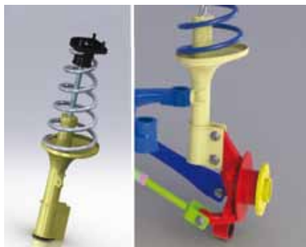
Obr. 13 Tlmič s pružinou a jeho pripevnenie k náprave
