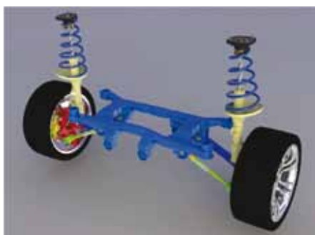
Obr. 15 Náprava s kolesami a brzdovým systémom
