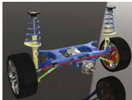
Obr. 18 Pohľad na celkový 3D model so stabilizátorom, rozvodovkou aj poloosami [1]
