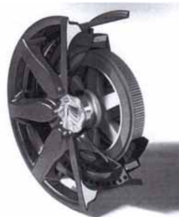
Obr. 18 Diskové koleso z materiálu vystuženého uhlíkovými vláknami s integrovaným kolesovým elektromotorom pre elektromobil
