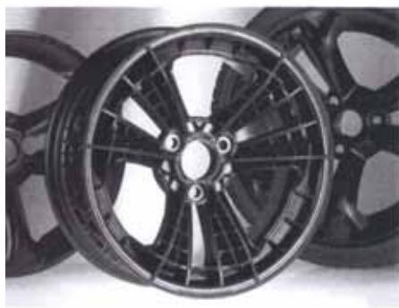
Obr. 17 Celoplastové diskové koleso Smart / BASF
