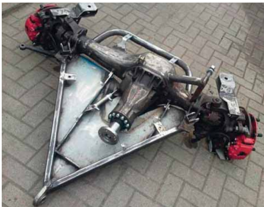
Obr. 5 - Riešenie zavesenia nápravy spôsobom One-link
