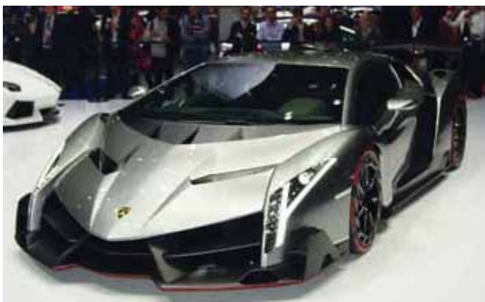
Lamborghini Veneno je pomerne drsne tvarovaný „supersport“, ktorý talianska automobilka vyrobí len v troch exemplároch. Výkonný 12-vaľcový motor s výkonom 552 kW mu umožňuje zrýchľovať z 0 na 100 km/h za 2,8 s a dosiahnuť najväčšiu rýchlosť 355 km/h
