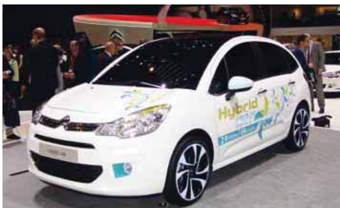
Konceptný automobil Citroën C3 Hybrid Air vybrali v PSA Peugeot Citroën ako demonštračné vozidlo nového hybridného pohonu týchto francúzskych automobiliek. V tomto hybridnom systéme spaľovací motor využíva podporu stlačeného vzduchu
