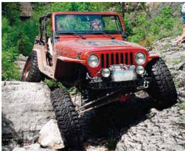
Obr. 2 - Příklad kríženia sa náprav
