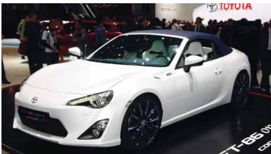
Toyota FT86 Open je zatiaľ len štúdiou s rozmermi 4240x1775x1270 mm. Má strechu z viacvrstvového textilu s integrovaným skleneným zadným oknom. Strechu možno sklopiť za zadné sedadlá, takže neovplyvňuje príliš veľkosť batožinového priestoru
