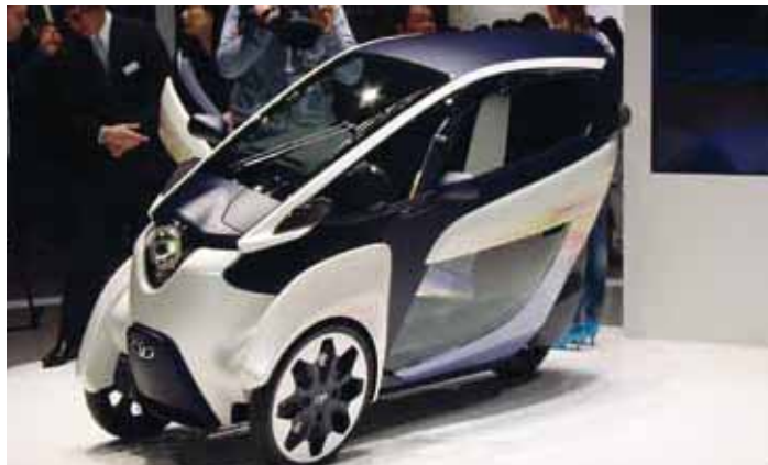
Toyota i-ROAD je malý elektromobil s dojazdom 50 km, ktorému systém aktívneho nakláňania karosérie umožňuje nepadnúť na bok ani po zastavení, napríklad na križovatke. Karosérie vozidla tak môže byť celkom uzavretá, s vykurovaním a ďalšími prvkami pohodlia
