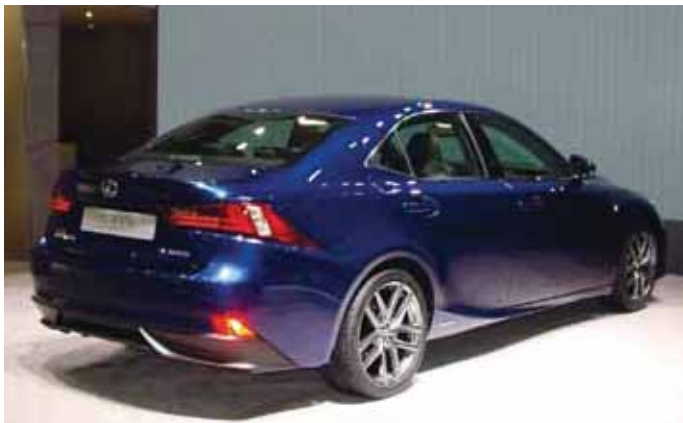
Tretia generácia automobilu Lexus IS má dynamickejší dizajn ako v druhej generácii. Model s hybridným pohonom IS 300h má trakčné batérie umiestnené tak, aby mal rovnaký objem batožinového priestoru ako model IS 250 poháňaný zážihovým motorom
