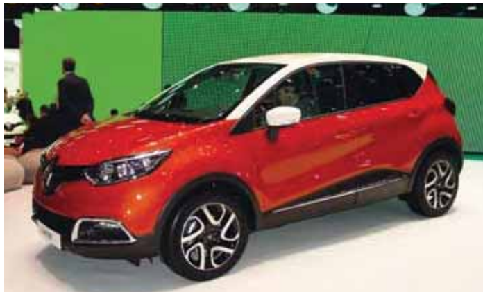
Crossover Renault Captur je postavený na konštrukčnom základe typu Clio. V ponuke má zatiaľ dvojicu motorov, oba s výkonom 66 kW. Dosahujú ho zážihový preplňaný trojvalec 0,9 TCe a vznetový štvorvalec 1.5 dCi
