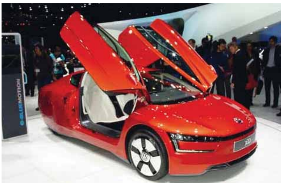
Volkswagen XL1 – koncept automobilu s „litrovou“ spotrebou paliva. Má hmotnosť len 750 kg vďaka rozsiahlemu využitiu uhlíkových kompozitov. Tie sú drahé, takže reálne zaradenie takéhoto vozidla do veľkosériovej výroby je rovnaké ako pri elektromobiloch...
