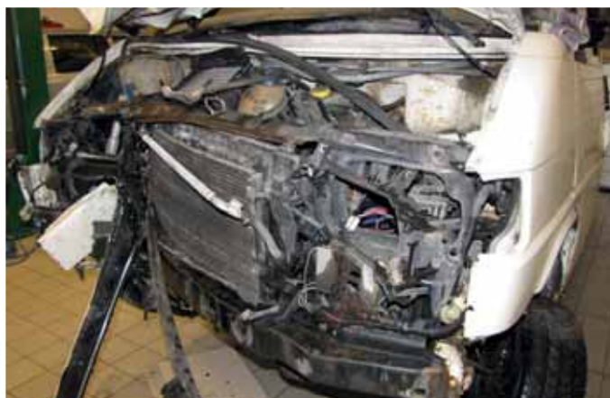
Obr. 2 Technická chyba vozidla (rozpojenie guľového čapu a strata ovládateľnosti) bola priamou príčinou dopravnej nehody s fatálnymi následkami. Vozidlo krátko predtým „vyhovelo“ kontrole v STK...
