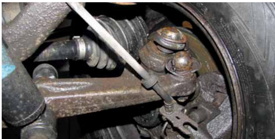
Obr. 1 Nesprávne posúdená alebo prehliadnutá nadmerná vôľa v zvislom čape vozidla pri pravidelnej technickej kontrole môže spôsobiť rozpojenie guľového čapu počas jazdy vozidla. Tak sa to stalo aj v tomto prípade
