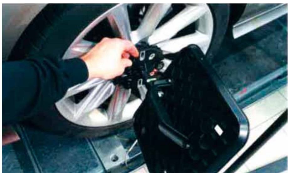
Princíp merania geometrie náprav 3D stereokamerovým systémom zariadenia BEISSBARTH VAS 6767 a magnetické držiaky odrazových terčov pre upevnenie na koleso.
