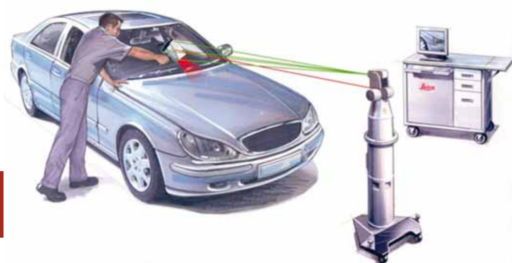
Obr. 8 - Princíp snímania tvaru a postavenie zariadenia a objektu pri skenovaní [1, 4]
