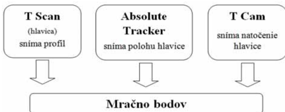
Obr. 7 - Princíp činnosti skenovacieho zariadenia Leica
