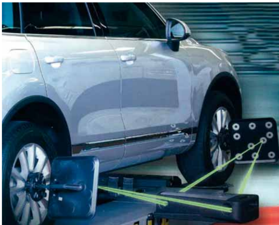
Princíp merania geometrie náprav 3D stereokamerovým systémom zariadenia BEISSBARTH VAS 6767 a magnetické držiaky odrazových terčov pre upevnenie na koleso.
