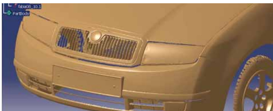
Obr. 11 - Vytvorenie triangulačnej siete a jej tieňované zobrazenie
