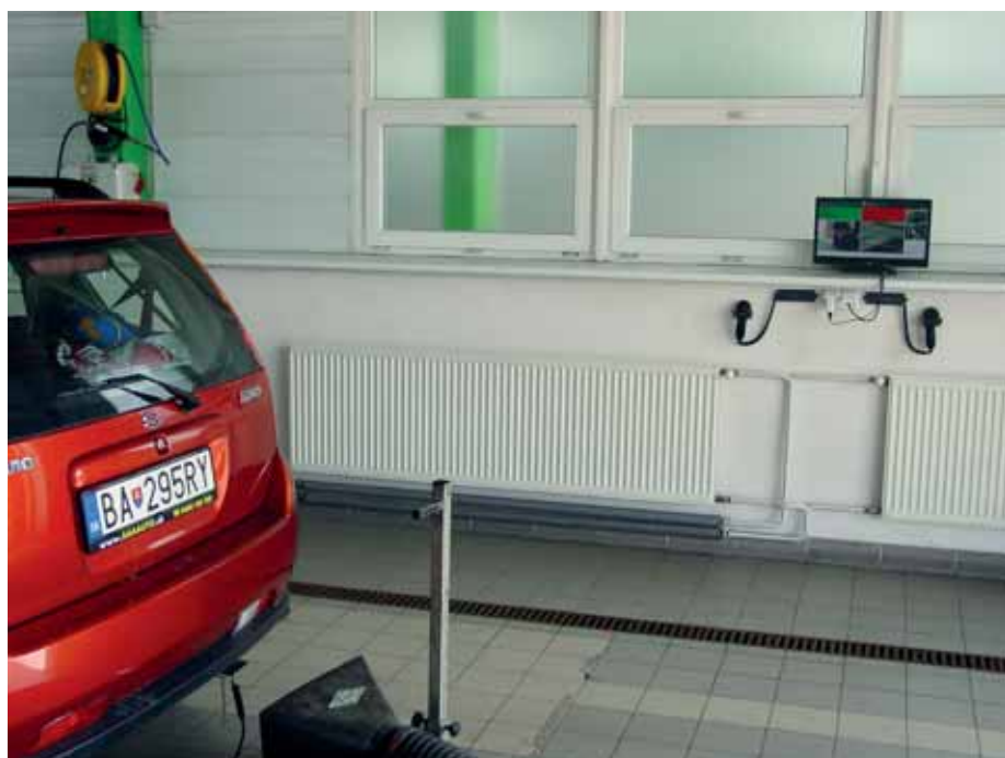
Zelené pole v ľavej časti obrazovky terminálu so zariadením na čítanie čiarového kódu svedčí o tom, že evidenčné číslo kontrolovaného vozidla bolo na začiatku linky spoľahlivo nasnímané (prípadná žltá farba by svedčila o opaku). Vozidlo môže prejsť všetkými kontrolnými bodmi na linke
