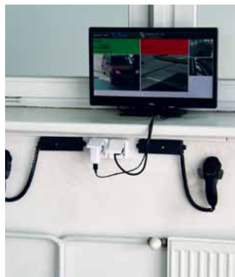
Zelené pole v ľavej časti obrazovky terminálu so zariadením na čítanie čiarového kódu svedčí o tom, že evidenčné číslo kontrolovaného vozidla bolo na začiatku linky spoľahlivo nasnímané (prípadná žltá farba by svedčila o opaku). Vozidlo môže prejsť všetkými kontrolnými bodmi na linke
