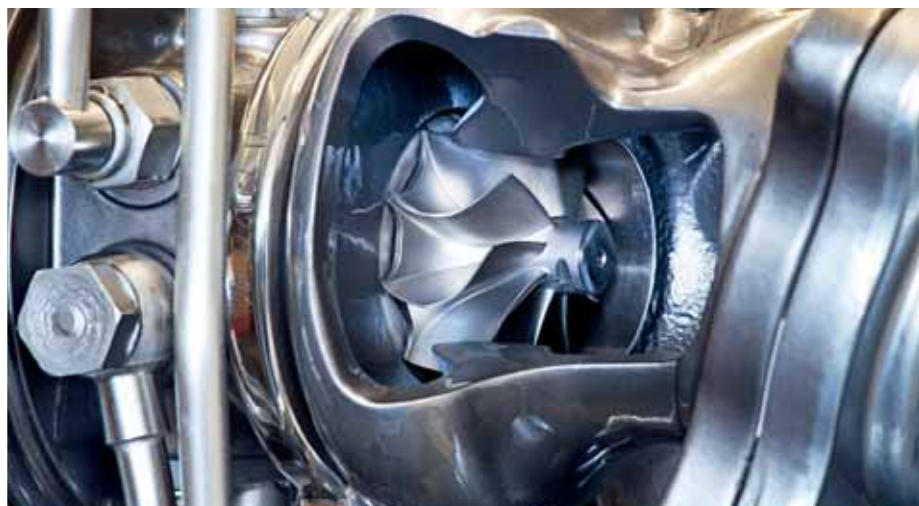
Turbodúchadlo motora 1.6 SIDI Turbo je bezprostredne spojené s motorom
