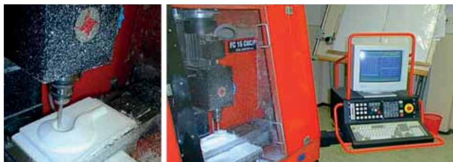
Obr. 6 Obrábanie modelov do polystyrénu na CNC frézovačke FC 16 CNC TOS Jasová [5]
