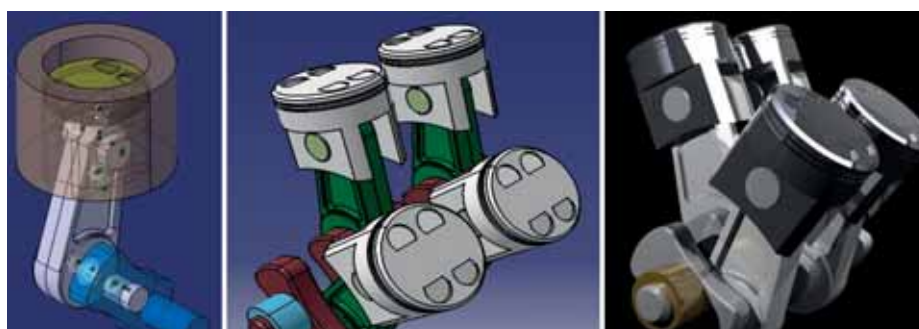
Obr. 7 Od jednovalca k štvorvalcu, od priradenia materiálu k vizualizácii [5]
