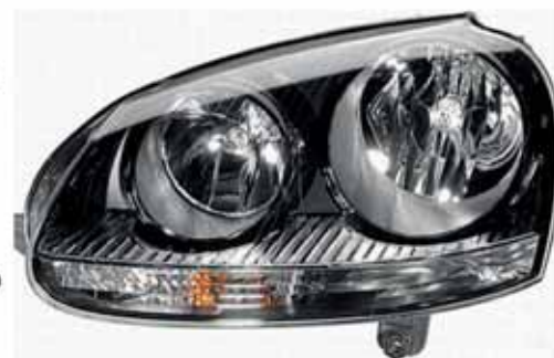
Obr. 1 Rozdiel medzi reflektormi s optikou na krycom skle a s čírym krycím sklom s optikou na parabole
