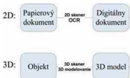
Obr. 10 Proces 2D a 3D digitalizácie [1]
