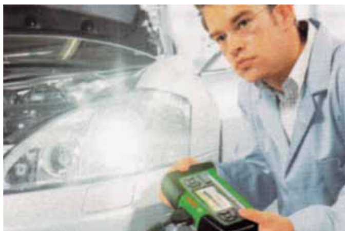
Dynamický systém regulácie nastavenia (sklonu) reflektorov možno skontrolovať len pomocou na to určeného diagnostického zariadenia
