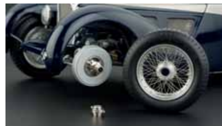
● Perfektné spice v správnom počte; funkčný dvojkrídlový centrálny uzáver s pravými/ľavými závitmi umožňujú veľmi rýchlu výmenu defektného kolesa – aj na modeli V M1:18
