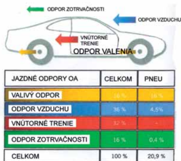
Obr. 4 Podiel rôznych odporov vozidla na jeho celkovom jazdnom odpore a príspevok samotných pneumatík; hodnoty typické pre skúšobný jazdný cyklus NEDC
