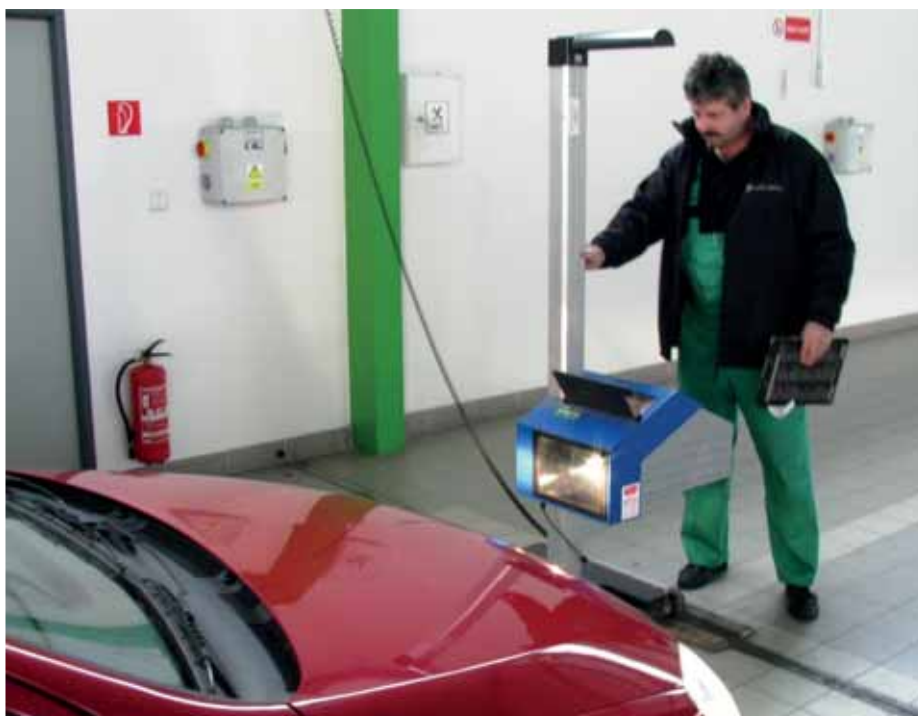
Kontrola a nastavenie xenónových reflektorov pomocou presného regloskopu je základným predpokladom správneho osvetlenia vozovky
