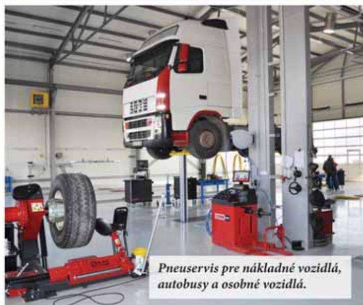
Možnosť zdvihnutia celej súpravy naraz, alebo využitia ako dva nezávislé zdviháky s úplným prístu- pom k podvozku vozidla.
