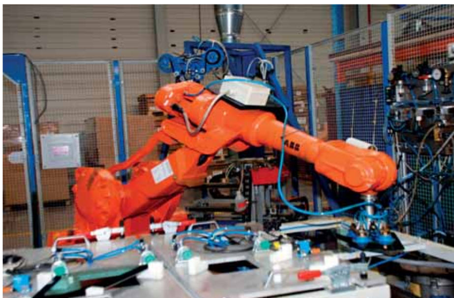
Robotické pracovisku na nanášanie lepidla na sklá
