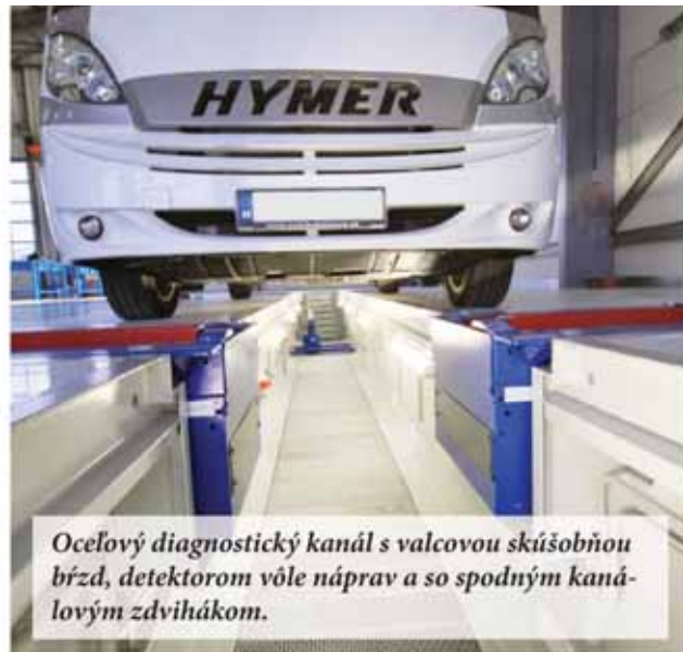
Valcová skúšobňa brzd Maha IW4 Eurosystem – meranie brzdných síl so softvérom na zosúla- ďovanie náprav.
