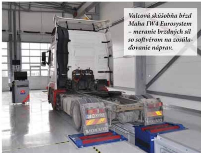
Oceľový diagnostický kanál s valcovou skúšobňou brzd, detektorom vôle náprav a so spodným kaná- lovým zdvihákom.
