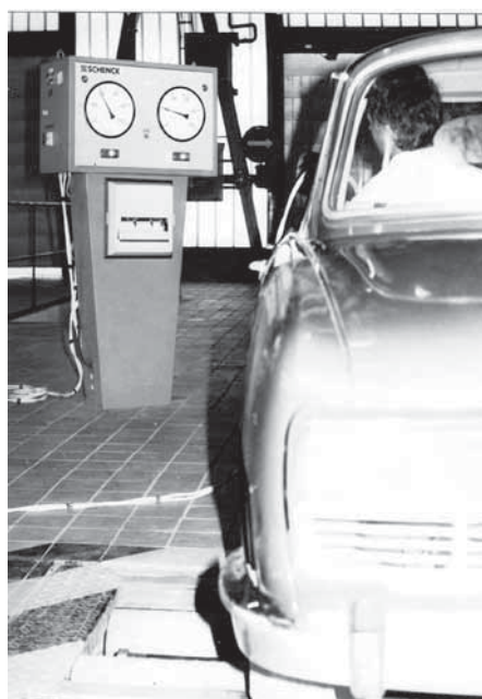
Obr. 5: Valcová skúšobňa brzd Schenck (typ R2i) v STK Bratislava dokončená v r. 1980 mala ešte pneumatický merací systém.
