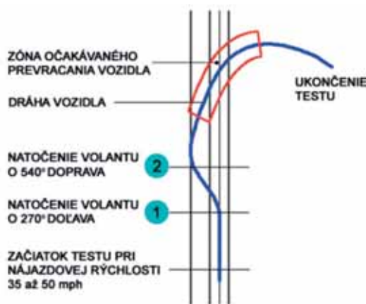
Obr. 1 Dráha skúšobného automobilu pri americkom „fishhook“ teste
