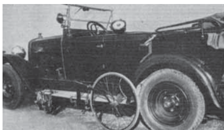
Obr. 1: Použitie piateho kolesa na meranie brzdných dráh v tridsiatych rokoch minulého storočia
