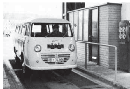
Obr. 4: Jedna z prvých plošinových skúšobní brzd využívaná na kontrolu účinku brzd automobilu pri technickej kontrole
