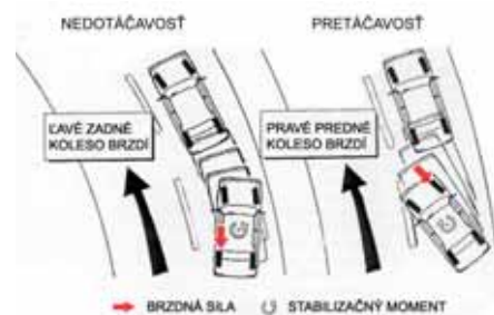
Obr. 6 - Brzdne zásahy regulačného systému ESP pri nedotáčavom a pretáčavom správaní sa vozidla v ľavotočivej zákrute
