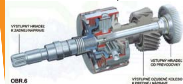
Obr. 6 Korunový diferenciál súčasnej tretej generácie Audi Quattro
