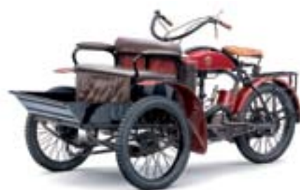
▲ Súbežne s motocyklami začiatkom minulého storočia vyrábali pod značkou L & K i trojkoliesky, ktoré slúžili aj ako taxíky. Na snímke je trojkolieska L&K Typ LW z roku 1911. Písmenom W označovali typy, ktorých motory boli chladené vodou (wassergekühlt)
