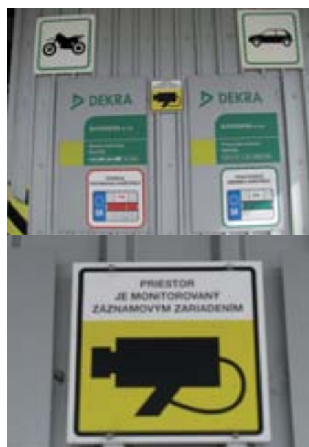
▲ Obr. 3: Požadované označenie priestorov STK a pracovísk emisných kontrol monitorovaných kamerami
