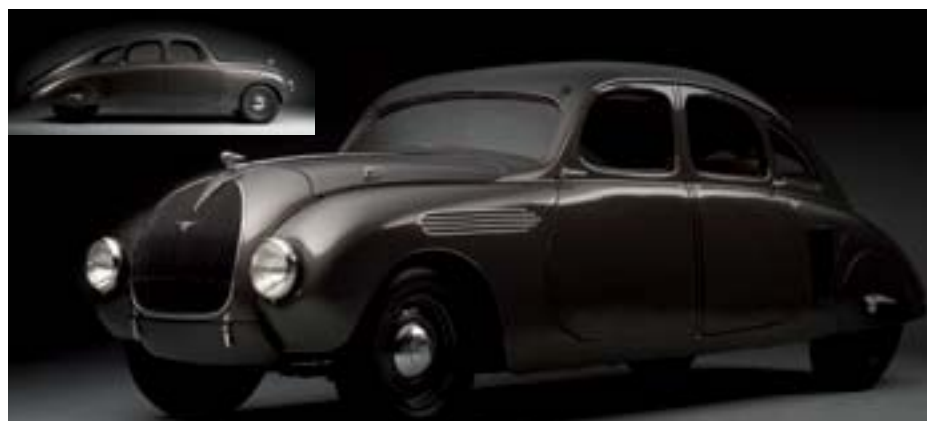
▲ Obr. 8. Príkladom prúdnicového dizajnu 30. rokov je päťmiestna Škoda 935 Dynamic z roku 1935. Pre zmenšenie hmotnosti sa v konštrukcii jej karosérie objavuje okrem ocele aj hliník
