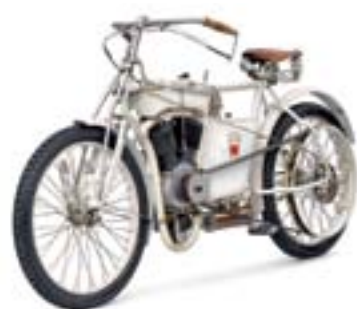
▲ L&K motocykleta Slavia typ CCD z roku 1906. Vyrábala sa s dvojvalcovým motorom a v rokoch 1904 až 1907 vyrobili 675 exemplárov. Vyrábala sa s dvojvalcovým motorom a v rokoch 1904 až 1907 vyrobili 675 exemplárov
