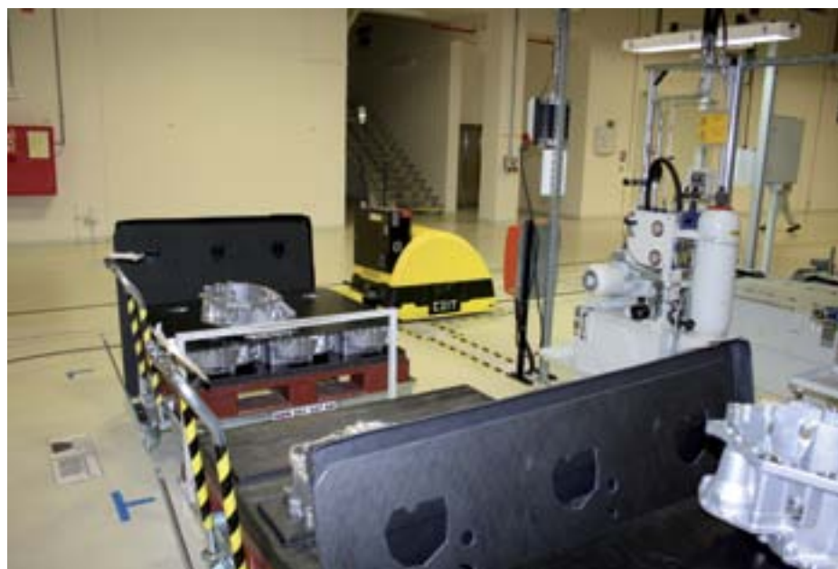
▲ Automatické vozíky na prepravu komponentov po výrobné hale prispeli k zlepšeniu bezpečnosti aj k zmenšeniu nákladov. Mimochodom, vyrobili ich na Slovensku
