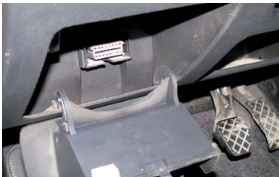
▲ Obr. 1: Príklad umiestnenia 16-pólovej normovanej diagnostickej zásuvky vo vozidle, ktorá umožňuje prenos dát
