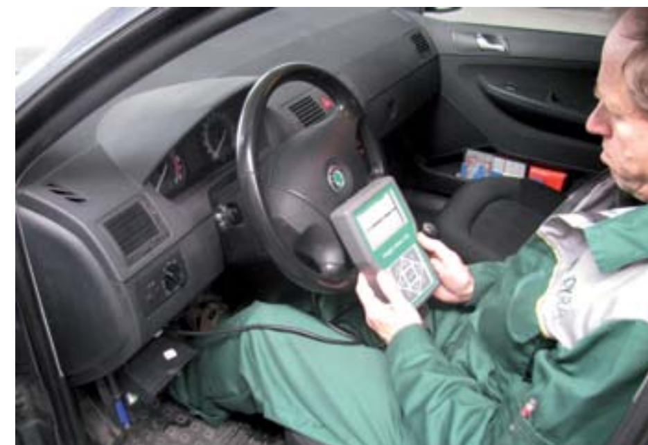
▲ Obr. 3: Diagnostické zariadenie (čítačka) po pripojení na diagnostickú zásuvku OBD vozidla umožňuje komunikáciu s riadiacimi jednotkami elektronických systémov, čítanie chybových hlásení, testovanie akčných členov a ďalšie úkony
