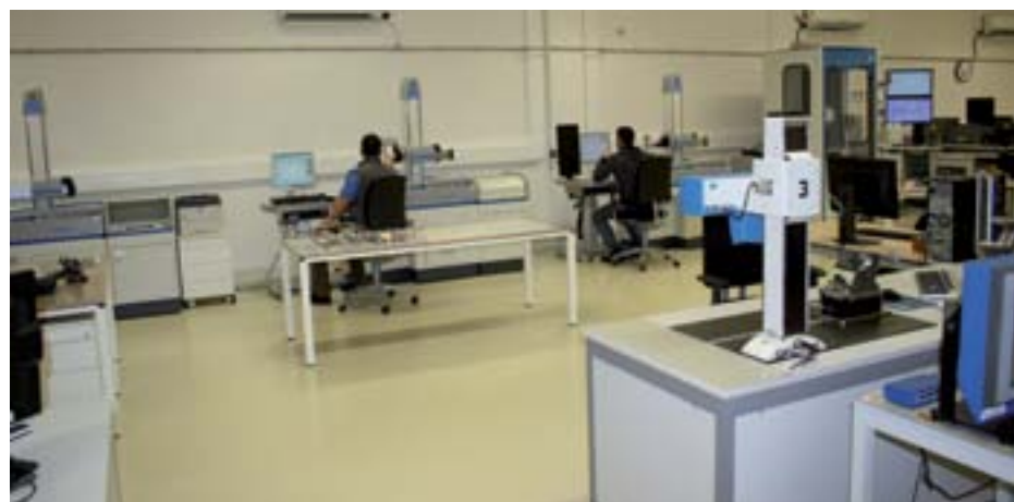
▲ Klimatizované meracie stredisko má podlahu oddelenú od obvodových múrov, aby sa do presných meracích strojov neprenášali vibrácie z výroby. Technici v ňom dokážu s výnimočnou presnosťou overovať správnosť vzájomnej polohy jednotlivých plôch komponentov prevodoviek, ich rozmery, vrátane drsnosti povrchu
