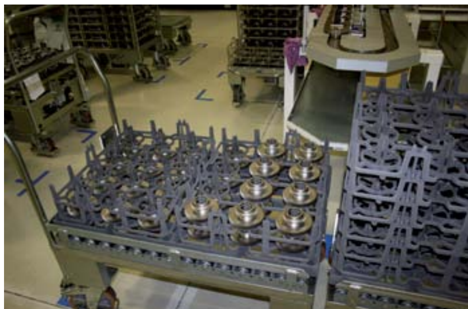
▲ Súčiastky pri povrchovom kalení sa vkladajú do špeciálnych roštov. Cena jedného sa vyrovná cene auta
