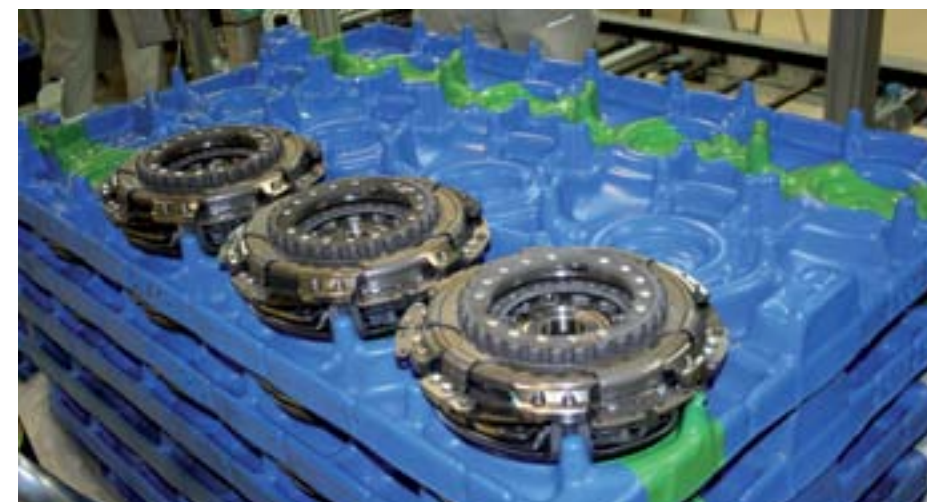
▲ Spojky pripravené na zamontovanie do prevodovky
