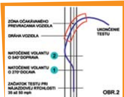
Obr. 2 Schematické znázornenie amerického „fish-hook“ testu
