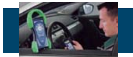
▲ Obr. 2: Použitie skúšobného adaptéra v spojení s malým vreckovým počítačom pri technickej kontrole
