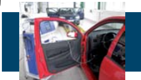
▲ Obr. 1: Emisná kontrola novších vozidiel so zážihovým (benzínovým) aj vznietovým (naftovým) motorom so systémom OBD je už doplnená o zisťovanie obsahu pamäte chýb
