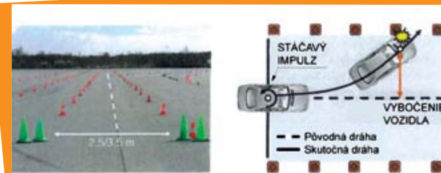
Obr. 4 Celková situácia a schematické znázornenie priebehu testu brzdením a vybočením z priameho smeru
