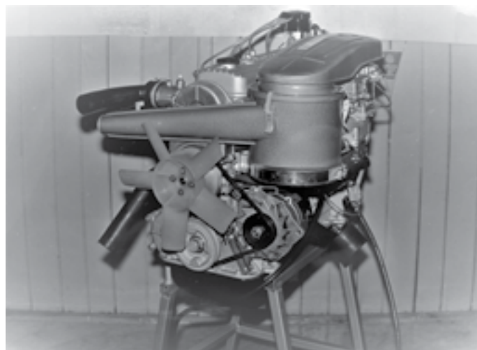
Štvorvalcový kvapalinou chladený zážihový motor s rozvodom OHC mal zdvihový objem 1498 cm 3 a výkon 62,5 kW. Blok motora, hlava valcov a sacie potrubia boli z hliníkového odliatku. Podľa dokumentácie z AZNP vzniklo v Považských strojárnach 21 prototypov motora Š720
