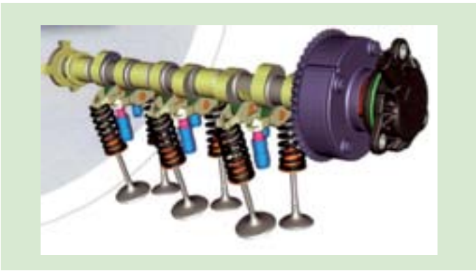
Obr. 7 CVCP – systém časovania ventilov prostredníctvom jediného včkového hriadeľa [2]
