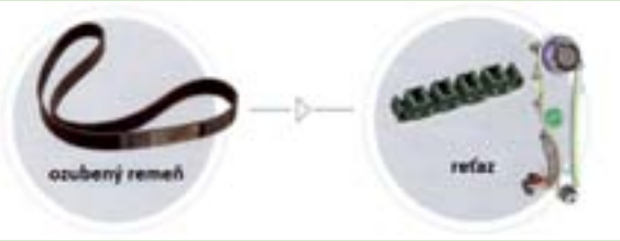
Obr. 8 Oproti motorom FIRE používa nová rodina GSE Firefly reťazou poháňaný rozvod [2]
