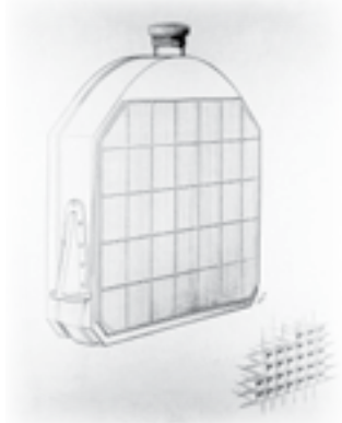
Nákres voštinového chladiča, ktorý vyvinul Wilhelm Maybach. Po prvýkrát ho použili vo vozidle Mercedes 35 PS, teda prvom modernom automobile, ktorého koncepcia je výsledkom práce Maybacha. Efektívny chladič umožňuje výrazné zváženie výkonu motora, používaný od roku 1903
