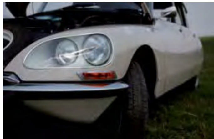
Svietil aj do zákruty. Diaľkové svetlá sa otáčali spolu s riadením
