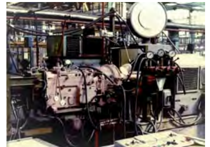
Polhodinová skúška funkčnosti každej vyrobenej prevodovky na zábehovom stave (meranie tlakov pracovnej hydrauliky, tesnosti spojov, hlučnosti, vibrácií, radenia prevodových stupňov). Výberovo bola robená až 100 hodinová skúška funkčnosti.
