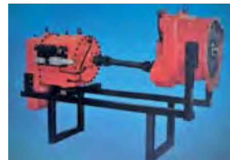
Prevodovka 4PR-160 (vľavo) sa do strojov montovala spolu s hydrodynamickým meničom zo závodu ŽŤS Hriňová (dnešné Hriňovské strojárne). Spájacie a kardanové hriadele dodával pobočný závod podniku ŽŤS Dubnica v Topoľčanoch (dnes TOPOS Tovarníky)
