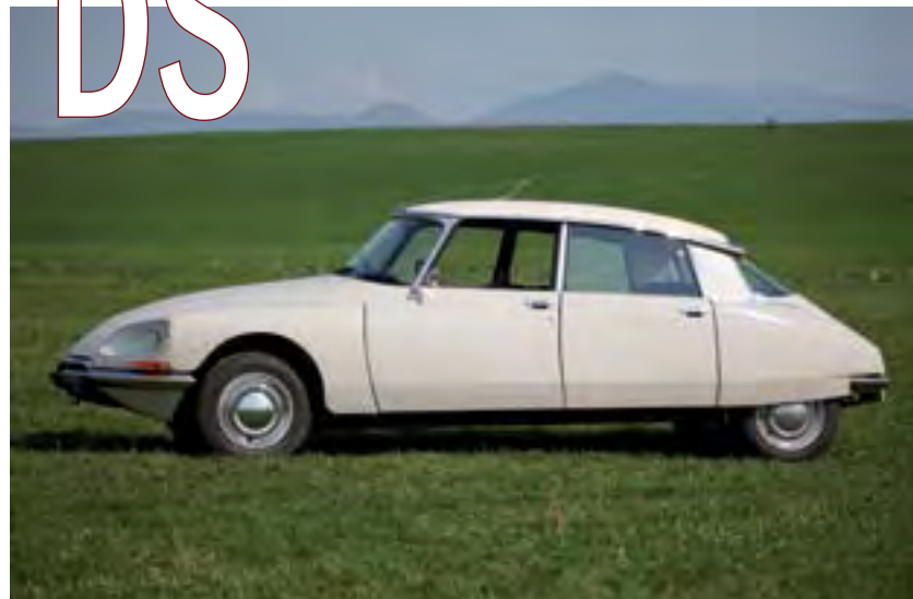
Hydropneumatické pruženie udržiavalo vozidlo počas jazdy v konštantnej výške. Rázvor náprav 3125 mm poskytuje posádke neuveriteľný priestor
