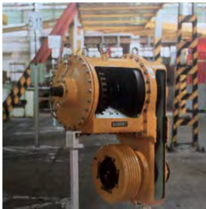
Jej jednotlivé verzie sa odlišovali hlavne prídavnou prevodovkou prispôbenou konštrukčným požiadavkám konkrétneho vozidla. Na fotografii typ určený pre kolesové nakladače UNC 200
