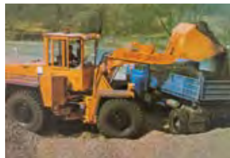
Univerzálny nakladač čelný UNC 200 (s prevodovkou 4PR-160) zavedený do sériovej výroby v ŽŤS Detva v roku 1978
