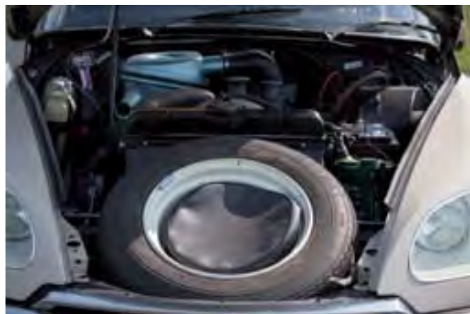
V predĺženej časti motorového priestoru našlo miesto i rezervné koleso, plnohodnotné, žiadna „dojazdovka“
