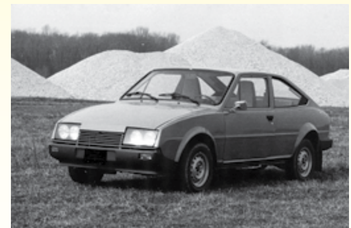
▲ Prototyp vozidla Locusta postaveného na základe upravenej karosérie Škoda Garde, ktorá okrem pozmenenej prednej masky dostala aj výklopné veko batožinového priestoru vzadu. Pohon zabezpečoval motor s prevodovkou a prednou nápravou prevzatý z automobilu Zastava 101 (F128)
