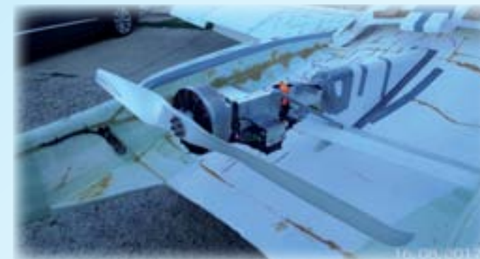
(Lietajúca maketa AirCar 1 elektrický pohon vrtule – z archívu autora)
