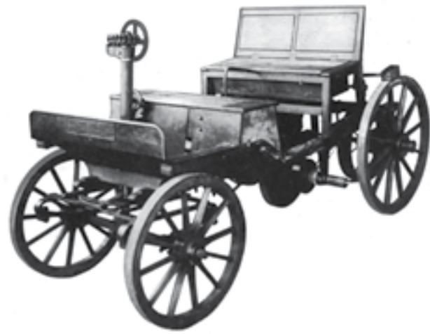
▲ Vozidlo-pohánane vodou chladeným štvortaktným jednovalcem s výkonom približne 055 kw vyrobené spoločnosťou MARKY BROMOVSKÝ - SCHULZ ADAMOV pri Brne 1888 -1889
