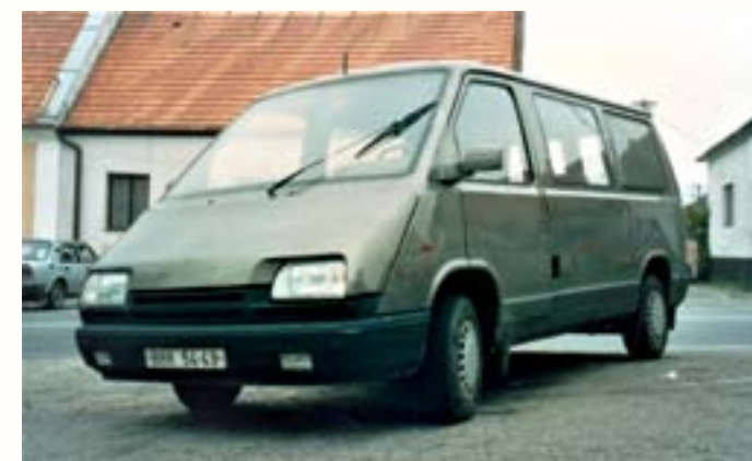
▼ Prototyp dodávkového automobilu MNA 900 s (na svoju dobu) modernou karosériou nadčasových tvarov. Automobil využíval niektoré dielce z (v tom čase ešte len vyvíjaného) typu Favorit
