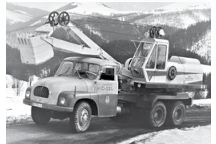
Modernizované lanové bagre D 031a montované na podvozky Tatra 138. Ich výroba bola po roku 1968 presunutá do pobočného závodu v Tisovci
