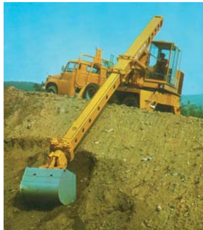
◀ Univerzálné dokončovacie stroje UDS sa začali vyrábať v závode Tisovec v polovici sedemdesiatych rokov. Na obrázku typ UDS 113a na automobilovom podvozku Tatra 148. Výroba strojov UDS dodnes pokračuje v spoločnosti CSM Industry Tisovec
