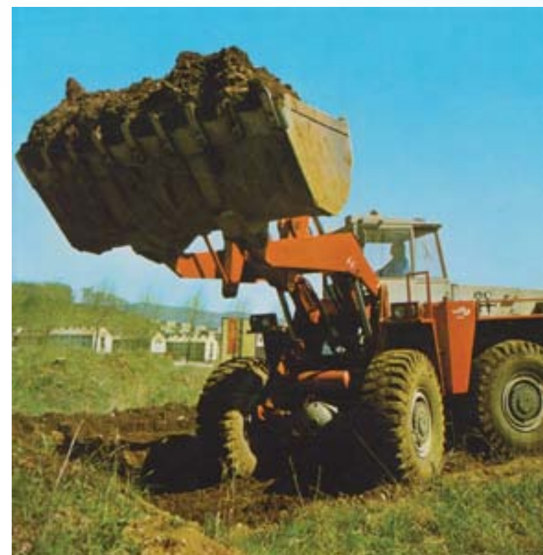
Jeden z prvých prototypov veľkého nakladača UNC 200 zo šesťdesiatych rokov. Modernizovaný typ UNC 201 sa vyrábal v období 1990-1998, jeho posledné série už boli osadené motormi Cummins
