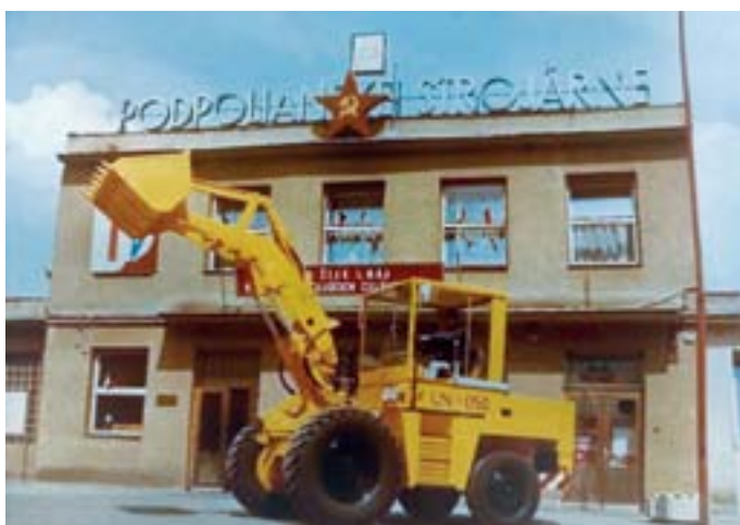
Nakladače HON nahradil od roku 1974 nový typ UN 050 s hydrostatickým pohonom a veľkou presklenou hranatou kabínou. Priemerná ročná produkcia tohto typu prekračovala dva tisíce strojov
