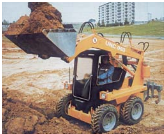
Legendárny šmykom riadený nakladač UNC 060. V závode Krupina vzniklo viac ako 13,5 tisíc strojov tohto typu, mnohé z nich sú dodnes v prevádzke. Bočné prevody vyrábali vo Vikanovej, prídavné zariadenia v Rimavskej Sobote. V Krupine v súčasnosti vyrábajú šmykom riadené nakladače pod značkou Locust
