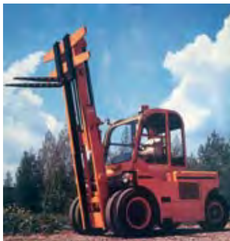
▲ Päťtonový vysokozdvížný vozík SV 50-I-33 s hydrostatickým pohonom (s plynulou zmenou rýchlosti bez nutnosti preradovať prevodové stupne) bol predstavený v roku 1985
