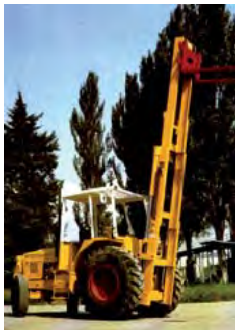
▲ Päťtonový vysokozdvížný vozík SV 50-I-33 s hydrostatickým pohonom (s plynulou zmenou rýchlosti bez nutnosti preradovať prevodové stupne) bol predstavený v roku 1985
