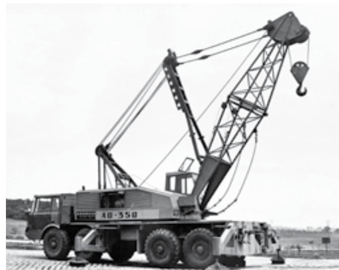
▲ Najväčší československý autožeriav AD-350 s nosnosťou 35 ton vyvinutý v Martine a montovaný na štvornápravové automobily Tatra 813 v závode Malacky. Výroba štandardných (menších) typov priehradových autožeriavov s nosnosťou 6-8 ton na podvozkoch Tatra 138/148 prebiehala v TEES Lučenec
