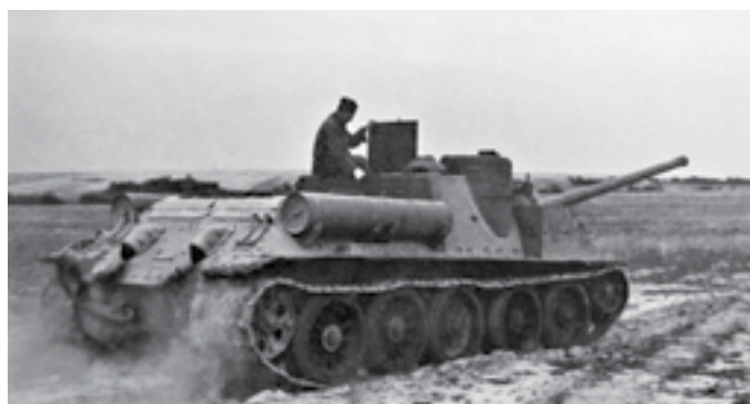
▲ Prvým výrobkom nosného programu boli licenčné tanky T-34, ktorých produkcia sa presunula z ČKD Praha. V rokoch 1952 až 1956 bolo vyrobených 1785 kusov pre čs. armádu a export. Na obrázku samohybné delo SD-100 postavené na podvozku T-34 počas skúšok. V rokoch 1954 až 1957 ich bolo vyrobených 641 kusov pre čs. armádu
