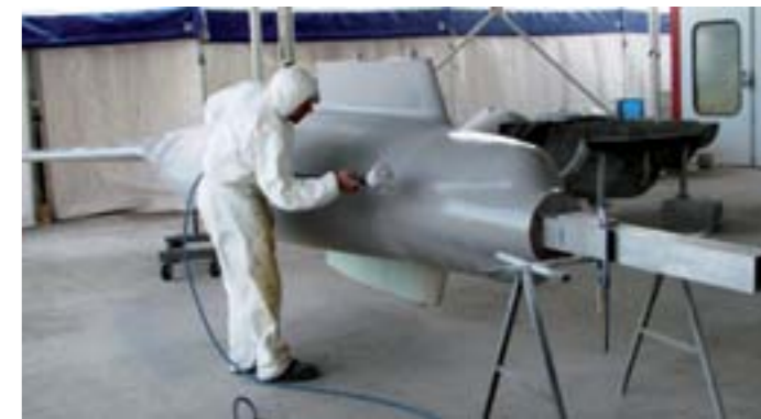
PRÍPRAVA MODELU TRUPU PRE VÝROBU NEGATÍVNYCH FORIEM
