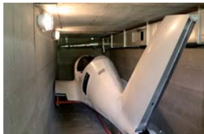
VYPALOVANIE TRUPU V PEČI A MONTÁŽ KOMPOZITOVÝCH DIELCOV TRUPU
