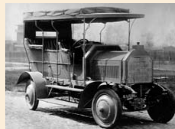
Automobil Daimler-Kolonial s pohonom a riadením na všetky kolesá, takzvaný „Dernburg-Wagen“. Vyrobený bol v roku 1907.
