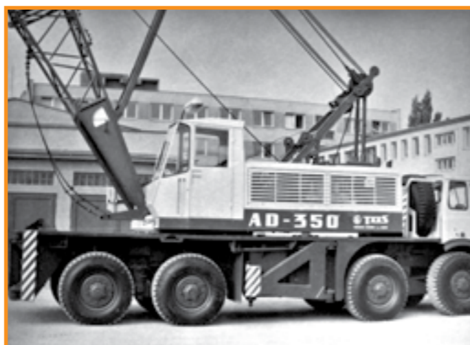
▼ Detailný pohľad na nadstavbu AD 350.1. Pod kapotou bol okrem iného umiestnený dieselelektrický agregát pozostávajúci z motora Tatra 924 a generátora jednosmerného prúdu
