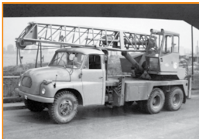
▲ Prototyp AD 070.1 ešte na staršom podvozku Tatra 138. V druhom polroku 1971 vyrobili v TEES Lučenec prvých 130 autožeriavov AD 070.1, v rovnakom roku dodali tiež posledných 370 autožeriavov AB 063.2
