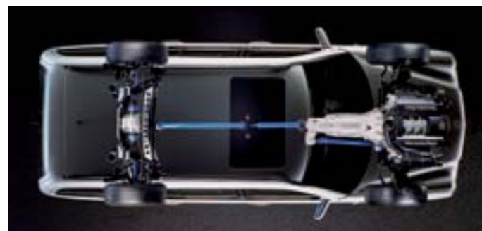
Systém pohonu 4MATIC vo vozidle Mercedes-Benz E z roku 1997
