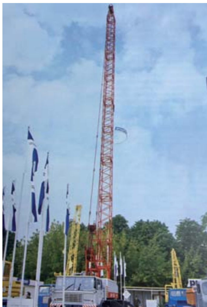
▲ Prototyp AD 070.1 ešte na staršom podvozku Tatra 138. V druhom polroku 1971 vyrobili v TEES Lučenec prvých 130 autožeriavov AD 070.1, v rovnakom roku dodali tiež posledných 370 autožeriavov AB 063.2
