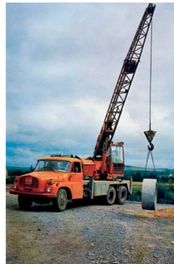
▼ Montážou ďalšieho dielca výložníka bolo možné zväčšiť výšku zdvíhu na 10 m. Autožeriav bol schopný pojazdu aj so zviazaným bremenom pri max. rýchlosti 5 km/h
