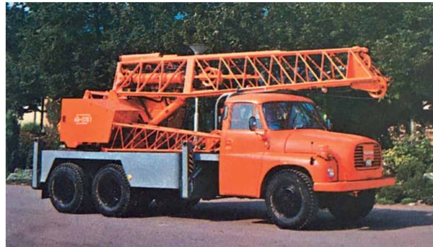
▲ Hydraulický otočný autožeriav AD 070.1 určený na dvíhanie, premiestňovanie a nakladanie bremien do maximálnej hmotnosti 7 ton. V rokoch 1971-1976 bolo vyrobených 2650 žeriavov AD 070.1 na podvozku Tatra 148
