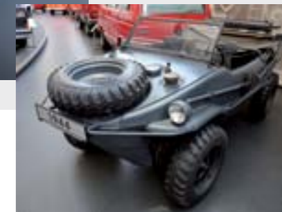
Obr. 8 Obojživelník KdF Schwimmwagen a sklopná lodná vrtuľa (foto: M. Fabian)
