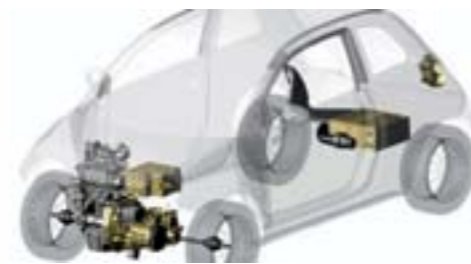
Obr. 10 Fiat 500 Hybrid (2013) - vpravo batéria, vľavo elektromotor v prevodovke [9]
