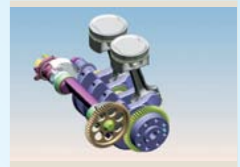
Obr. 4 Vyvažovací hriadeľ pripojený pomocou ozubeného prevodu [3]
