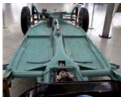
Obr. 26 Podvozok VW Chrobák [12],[13]
