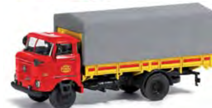
IFA WS50L Sp (špedičné) prepravné vozidlo jeho vlastníka MINOL – tu so značkou Espewe. Základný typ dvojosiach úžitkových vozidiel mal nosnosť do 5 t, určený bol aj na export
