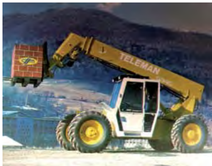
▲ V kooperácii so spoločnosťou Gradall vyrobený teleskopický manipulátor TELEMAN 534C
