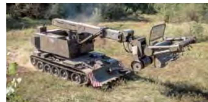
◀ Špeciálne nadstavby UDS upravené pre nasadenie v ženijnom vojsku boli montované i na tankové podvozky. Na fotografii odtarasovací stroj UOS-155 Belarty
