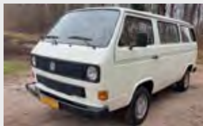
Obr. 12 VW T3 so vzduchom chladeným motorom (vľavo) [5] a s vodou chladeným motorom (vpravo), vodou chladeným verziám pribudla medzi smerovky jedna vstupná mriežka k chladiču vody
