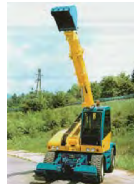
▲ Univerzálny pracovný stroj UPS 112 na kolesovom podvozku. Okrem neho je v ponuke tiež inovovaná verzia teleskopického manipulátora UTM 11.34
