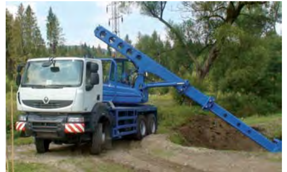
▲ Nová generácia UDS 214 so základným objemom lopaty 0,63 m 3 je určená pre výkopové a dokončovacie práce, budovanie infraštruktúry a inžinierskych sietí, úpravu tokov riek a odvodňovacích kanálov, či pomoc pri živelných pohromách a prírodných katastrofách
