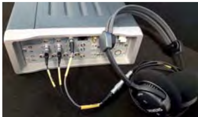
Obr. 3 Vybavenie na záznam zvuku v interiéri vozidla
