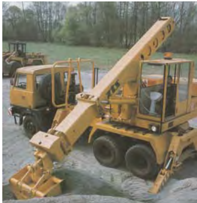
▼ Najrozšírenejší typ UDS 114a. Celkovo bolo vyrobených zhruba 5 tisíc strojov tohto radu, pričom najväčší počet - 4110 nadstavieb UDS 114a v období 1983 až 1990. Väčšina z nich bola montovaná na podvozky Tatra 815
