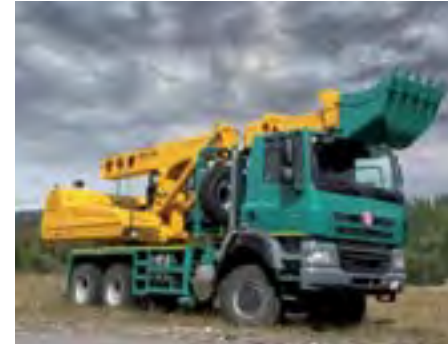
▲ Nová generácia UDS 214 so základným objemom lopaty 0,63 m 3 je určená pre výkopové a dokončovacie práce, budovanie infraštruktúry a inžinierskych sietí, úpravu tokov riek a odvodňovacích kanálov, či pomoc pri živelných pohromách a prírodných katastrofách
