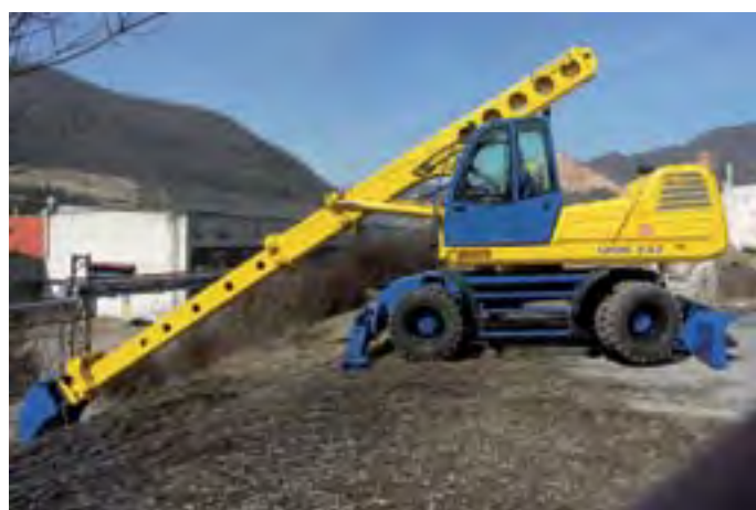
▲ UDS 232 na kolesovom podvozku s pohonom všetkých kolies
