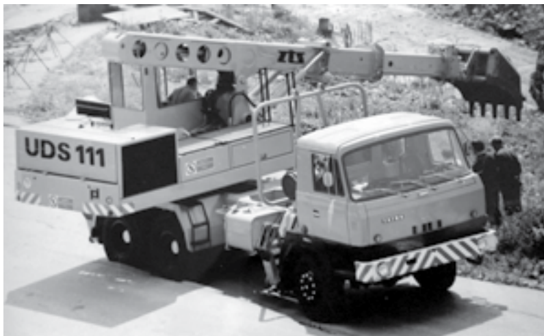
◀ Prototyp UDS 111a na predsériovom podvozku Tatra 815
