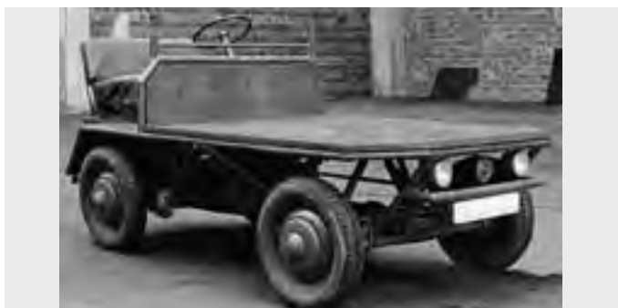
Obr. 1 Prepravník dielcov na podvozku VW „Chrobák“ – „Plattenwagen“ [1]
