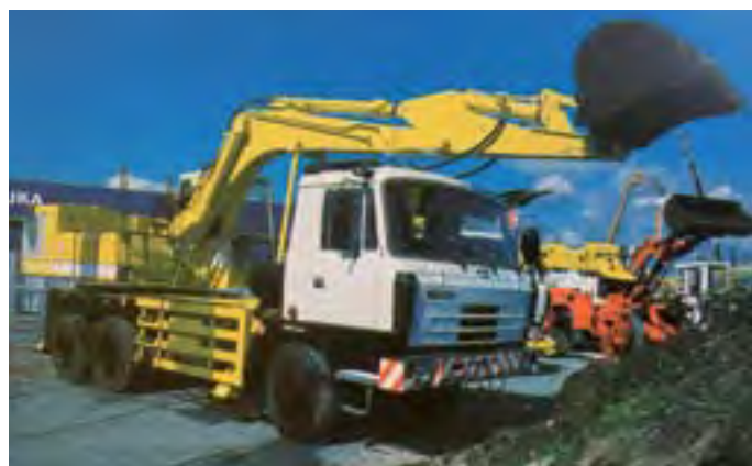
Nadstavba hydraulického rýpadla DH-214 na automobilovom podvozku Tatra 815 bola unifikovaná s novou generáciou UDS 214. Do výroby bol zavedený i odvodený model DH-311 na pásovom podvozku
