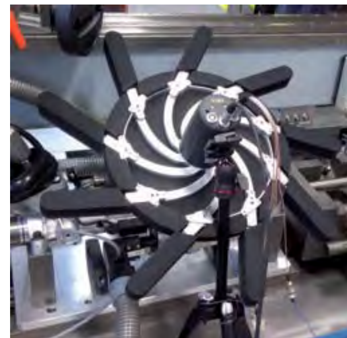
Obr. 5 Lokalizácia zdrojov zvuku pomocou akustickej kamery
