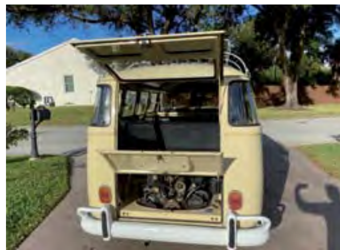
Obr. 4 Prístup k motorovému priestoru a prístup do skrine vozidla [3]
