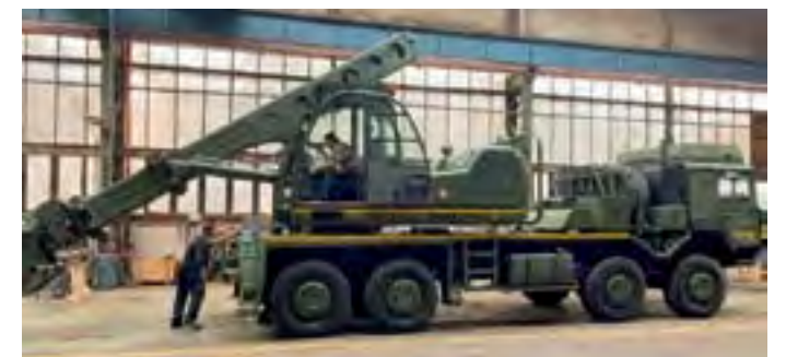
▲ Jedna zo špeciálne upravených verzií UDS 214 pre armádu na podvozku nemeckej značky Rheinmetall MAN HX 8x8 vo výrobnej hale podniku
