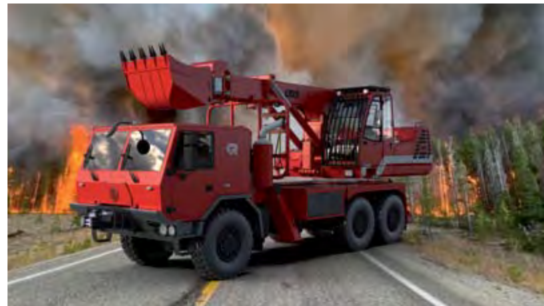
◀ UDS 214 na hasenie lesných požiarov na podvozku Tatra 815-7 pripravené v spolupráci s rakúskou spoločnosťou Rosenbauer
