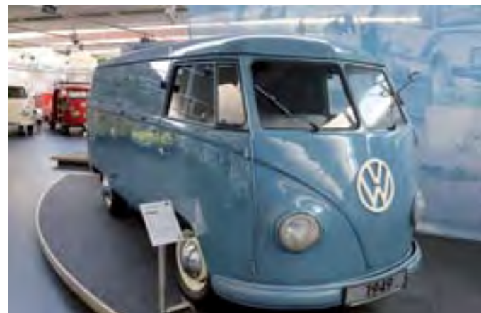
Obr. 3 Prototyp VW T1 s dvojkridlovými bočnými dverami a deleným čelným sklom z roku 1949 (foto: M. Fabian)
