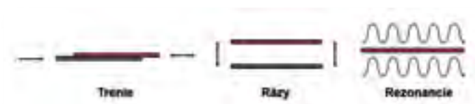
Obr. 1 Mechanizmus vzniku S/R/B hlukov
