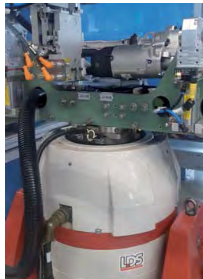
Obr. 4 Vibračné testovanie systému riadenia
