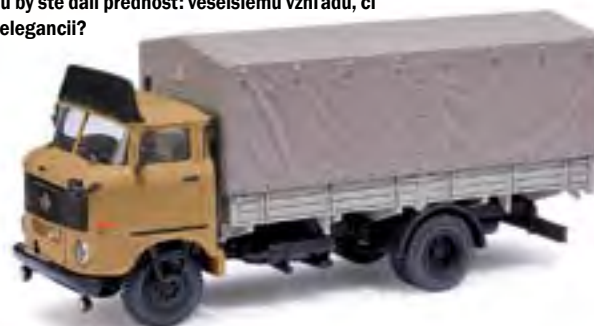
IFA WS50L Sp (špedičné) prepravné vozidlo jeho vlastníka MINOL – tu so značkou Espewe. Základný typ dvojosiach úžitkových vozidiel mal nosnosť do 5 t, určený bol aj na export
