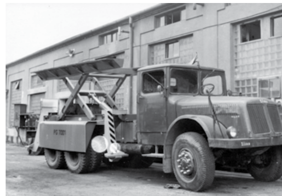
▲ K zaujímavým jednoúčelovým nadstavbám vyvinutým v Bratislave patrí prepravník prefabrikovaných betónových garáží PG 7001 na vozidle Tatra 111
