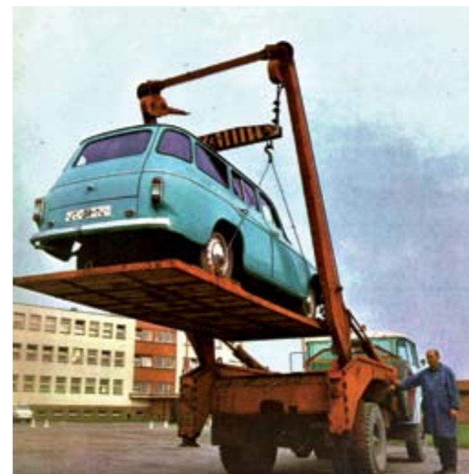
◀ Vaňový ramenný nakladač VRN 7 s maximálnou nosnosťou háku 7000 kg na podvozku LIAZ Š706 RTS
