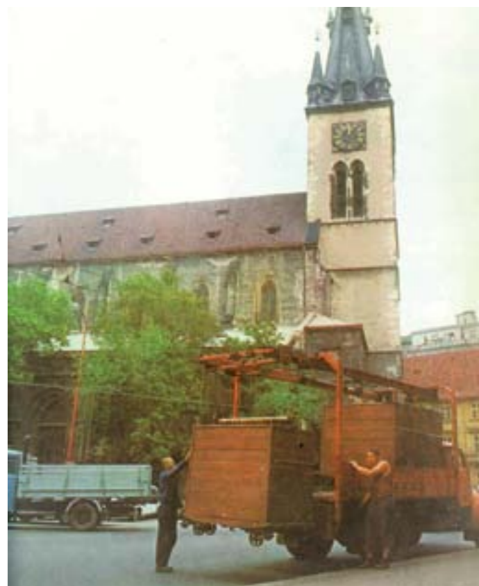
◀ Nadstavba VUD-3 na valníku Praga S5T určená na prepravu kontajnerov ČSD či kusových zásielok v rozvozovej službe ČSAD
