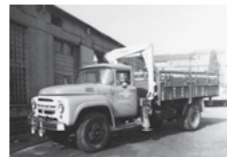
▲ HR 2502 na podvozku ZIL pre maďarskú dopravnú spoločnosť Volán Budapešť. Pre rovnakého odberateľa boli dodávané i ramenové nakladače RN 5005
