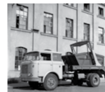
◀ HR 2501 s nosnosťou 2500 kg sa najčastejšie montovala na valníkové automobily LIAZ Š706 RT. Výrobu zabezpečoval závod v Trnave
