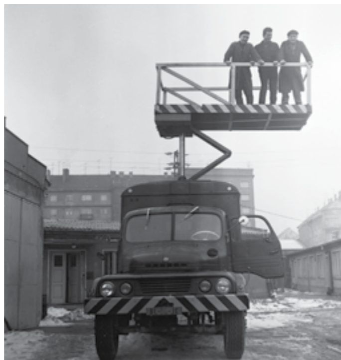
▼ Montážna plošina MP 0301 na vozidle Praga S5T na výstavbu a údržbu trolejového vedenia v mestách
