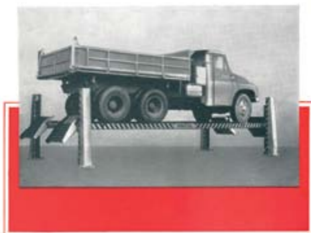
▲ Hydraulický 4-stojanový plošinový zdvihák ZN 2711 pre nákladné automobily a autobusy do celkovej hmotnosti 12 000 kg zo závodu Dopravostroj Nitra
