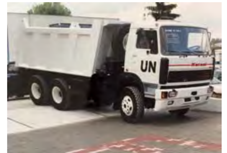
▼ Prototyp z deväťdesiatych rokov postavený na podvozku T815 s kabínou LIAZ (archív Jozef Filanda)
