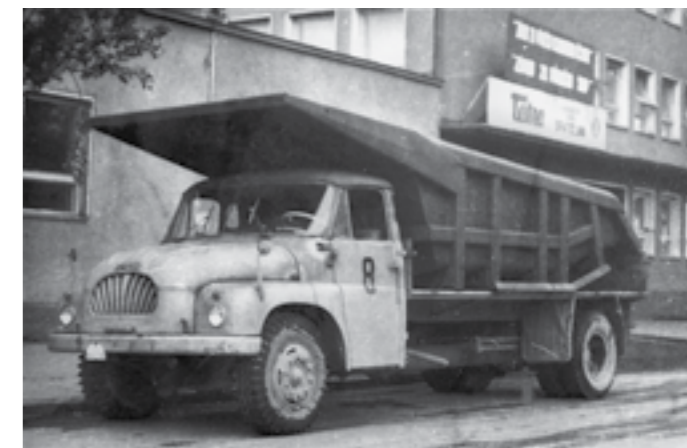
Sklápacia korba pre prototyp T813 S1 6x6 prepravovaná na plo-šine vozidla T138 4x4 pred závozom na Mlynských Nivách 21 (archív Ivan Šuster)
