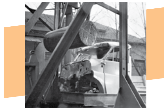
Skúška pasívnej bezpečnosti kabíny nákladného automobilu na ná-dvorí závodu Tatra Bratislava (archív Ivan Šuster)
