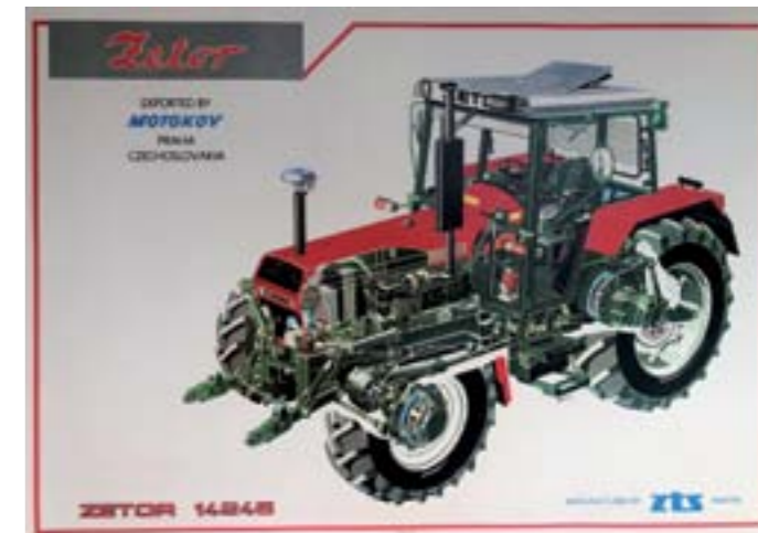
Rez traktorom Zetor 14245 inovovaného radu UR11C (foto ZTS, archív MT Marko)
