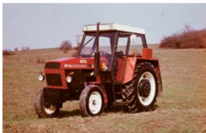
Základný predstaviteľ modernizovaného radu UR11B s jednoduchou prednou nepoháňanou nápravou (foto ZTS, archív Jaroslav Ruttkay)
