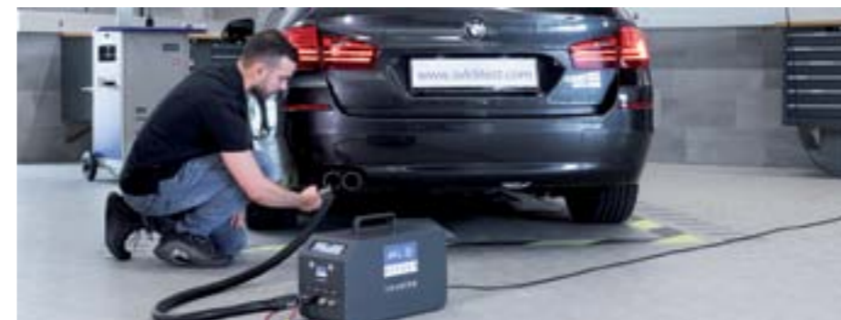
◀ Obr. 3: Prístroj na meranie počtu častíc vo výfukových plynoch AVL DiTest COUNTER
