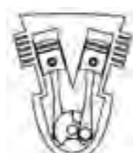
◀◀ Obr. 7 Porovnanie klasického V usporiadania valcov a riešenie VR6 (12-ventilové šesťvalce)
