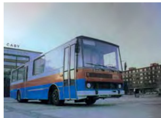
Automobilová pošta Karosa C-734-135 AP. Autobusový podvozok Karosa C-734 poháňal ležatý motor LIAZ ML636 s výkonom 152 kW, vozidlo dosahovalo maximálnu rýchlosť 100 km/h
