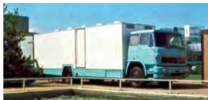
Prepravník jednodňovej hydiny LIAZ 110.060 vystavený na Agrokomplexe v Nitre v roku 1986. Postavený bol na nízkoúložnom šasi vyvíjanom ako náhrada za už v tom čase morálne zastarané vozidlá radu RTD
