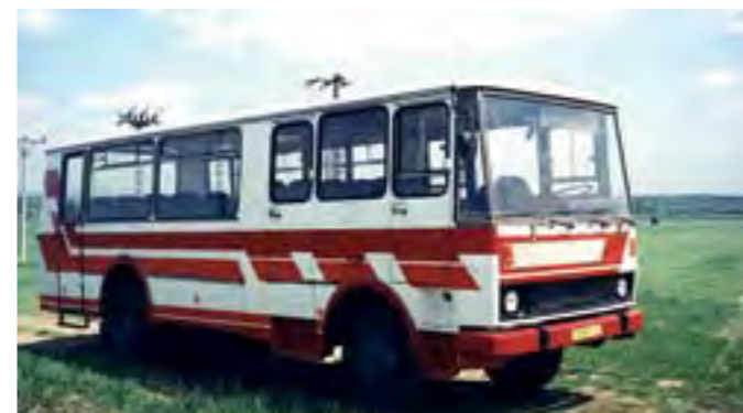
Terénny prepravník osôb EMIBUS s kapacitou 35 osôb umiestnený na podvozku LIAZ 101.860 4x4
