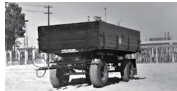
▲ V šesťdesiatych rokoch tvorili významnú časť produkcie vtedajšieho závodu BSS, neskôr Agrostroj Malacky rôzne verzie príviesov určených hlavne pre poľnohospodárstvo. Na obrázku hydraulicky sklopný traktorový prívies PzTS-6 s nosnosťou 6 ton
