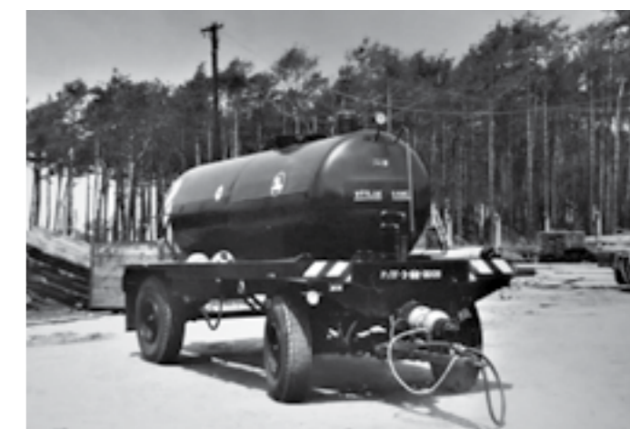
▲ Fekálny traktorový prívies PzTF-3 s objemom 3000 litrov vyrábaný v pomerne veľkých sériách až do polovice sedemdesiatych rokov
