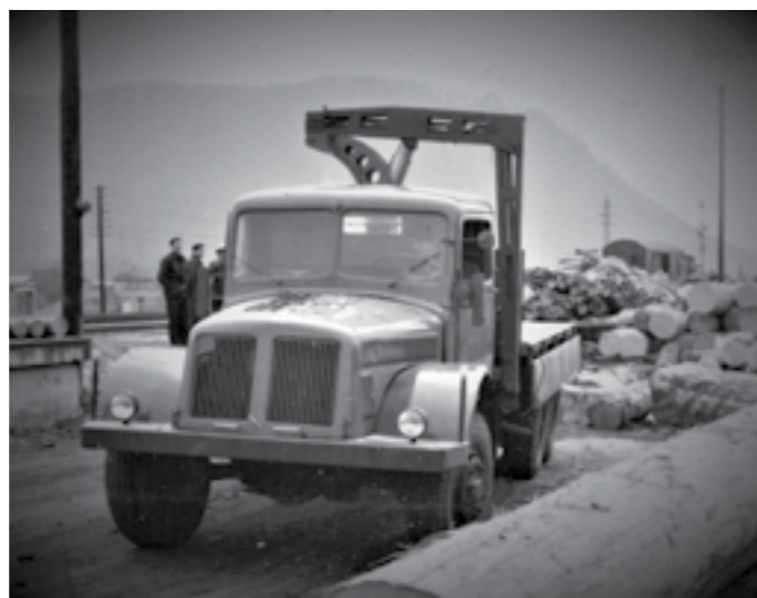
▲ Hydraulický žeriav HŽP-4-60 zo začiatku šesťdesiatych rokov osadený na nákladnom automobile Tatra 111 (foto archív SL Slovakia, a.s.)
