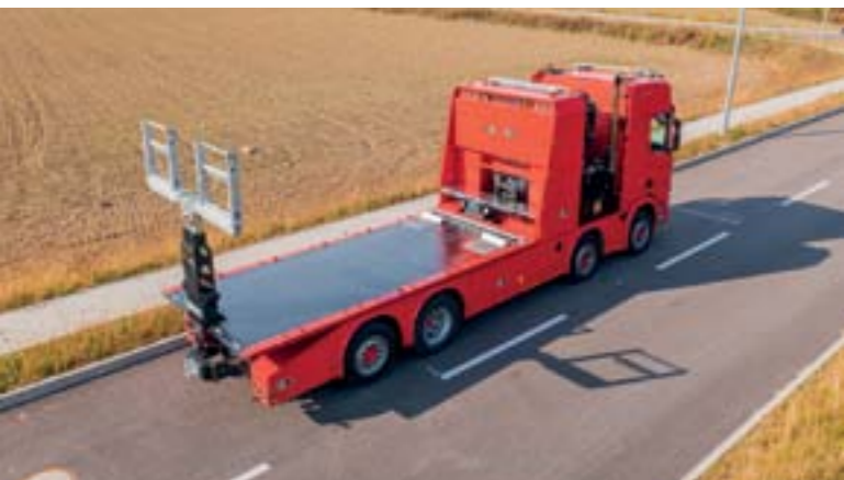
◀ Vozidlo ESSEL Towing ET12000 s nosnosťou plošiny 12 000 kg a nosnosťou ťažného zariadenia 7500 kg pri výsuvе 1500 m (foto archív SL Slovakia, a.s.)
