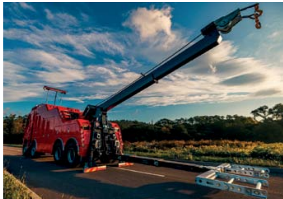
◀ Vyslobodzovací a odťahový špeciálny automobil ESSEL T-REX na štvornápravovom podvozku s celkovou kombinovanou ťažnou silou 80 000 kg na zábere s vysunutými ramenami. Vybavený je až piatimi navijakmi. Dva 24-tonové sú namontované na hlavnom žeriavovom výložníku. Ďalšie dva, 12-tonové sú inštalované na nadstavbe s bočným vedením lana v blízkosti podvozku vozidla. Najmenší, 8-tonový navijak je na predných podperných nohách a môže byť použitý na obojstranné ťahanie (foto archív SL Slovakia, a. s.)
