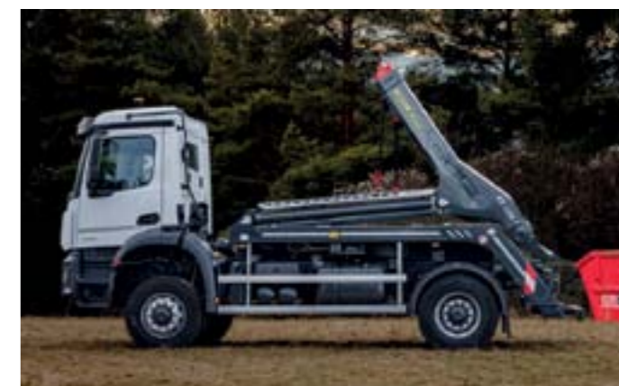
▼ K novým výrobkom patria ramenné nakladače kontajnerov typu ESSEL Skipper ES120T s nosnosťou 12 000 kg (foto www.essel.sk)
