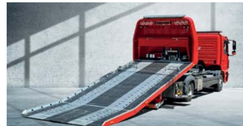
► Odťahová plošina ESSEL Towing ET5000 Superlift svojou konštrukciou umožňuje vyťahovať a vyslobodzovať vozidlá aj z roklín, priekop, fjordov a iných miest so strmým klesaním (foto archív SL Slovakia, a.s.)
