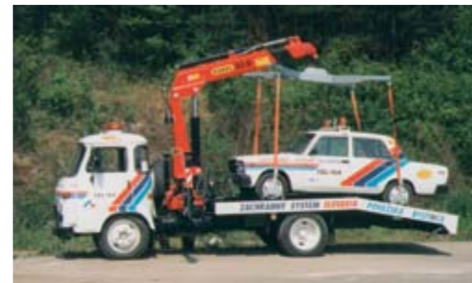
▲ Odťahový automobil Avia klasickej koncepcie s hydraulickou rukou ESSEL 90B z deväťdesiatych rokov (foto archív SL Slovakia, a.s.)
