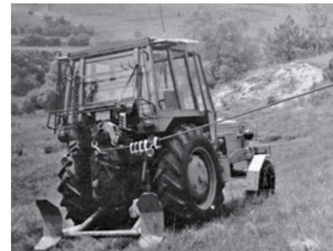
▲ Lesnícka približovacia súprava inštalovaná na traktore Zetor s navijakom patrila taktiež k typickým výrobkom podniku (foto archív SL Slovakia, a.s.)
