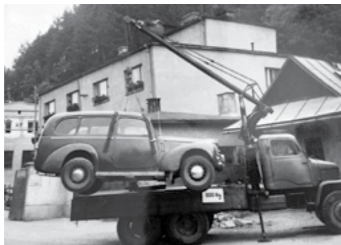
▼ Valník Praga V3S s hydraulickým žeriavom typu T mohol slúžiť aj k odťahu osobného automobilu (foto archív SL Slovakia, a.s.)
