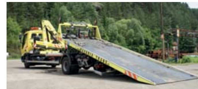
▲ Odťahová výsuvná plošina TP400 v kombinácii s hydraulickou rukou ESSEL 90A na podvozku Avia radu D z roku 2008 (foto archív SL Slovakia, a.s.)
