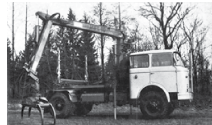
▼ Hydraulická ruka HARA namontovaná na ťahači LIAZ Š706 RTTNP s pohonom všetkých štyroch kolies (foto SL PTR n.p. Olomouc).
