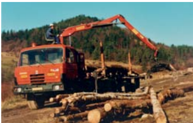
▼ Lesnícka hydraulická ruka ESSEL 90Z z deväťdesiatych rokov na odvoznú súpravu Tatra 815 (foto archív SL Slovakia, a.s.).
