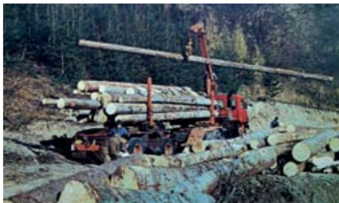
▼ Odvozná súprava Tatra 815 s hydraulickou rukou HARA 120. Hydraulické ruky boli od roku 1991-1992 dodávané už pod novým označením ESSEL (foto SŠL š.p./archív Juraj Šuhaj)
