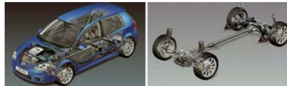
Obr. 11 Prierezový obrázok VW Golf s pohonom 4Motion a samotné riešenie pohonu
